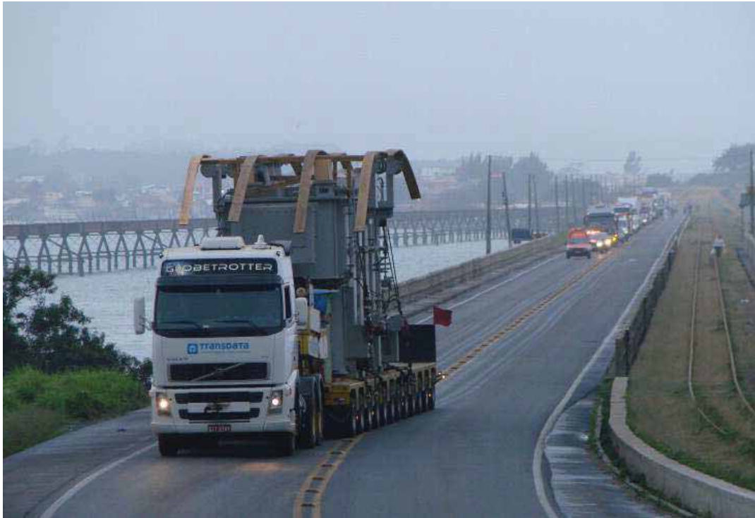
FIGURA 1 - Reboque Linha de Eixos transportando transformador na BR-101. (Fonte: CLICRBS, 31/08/2010)
