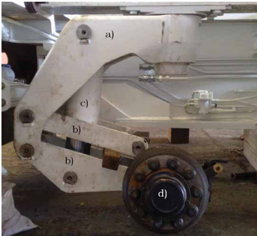
FIGURA 15 – Conjunto Suspensão Hidráulica RB.04LE-01 com os componentes: a) Corpo da suspensão, b) Braços articulados, c) Pistão Hidráulico e d) Eixo Aro 15'' com freio a disco
