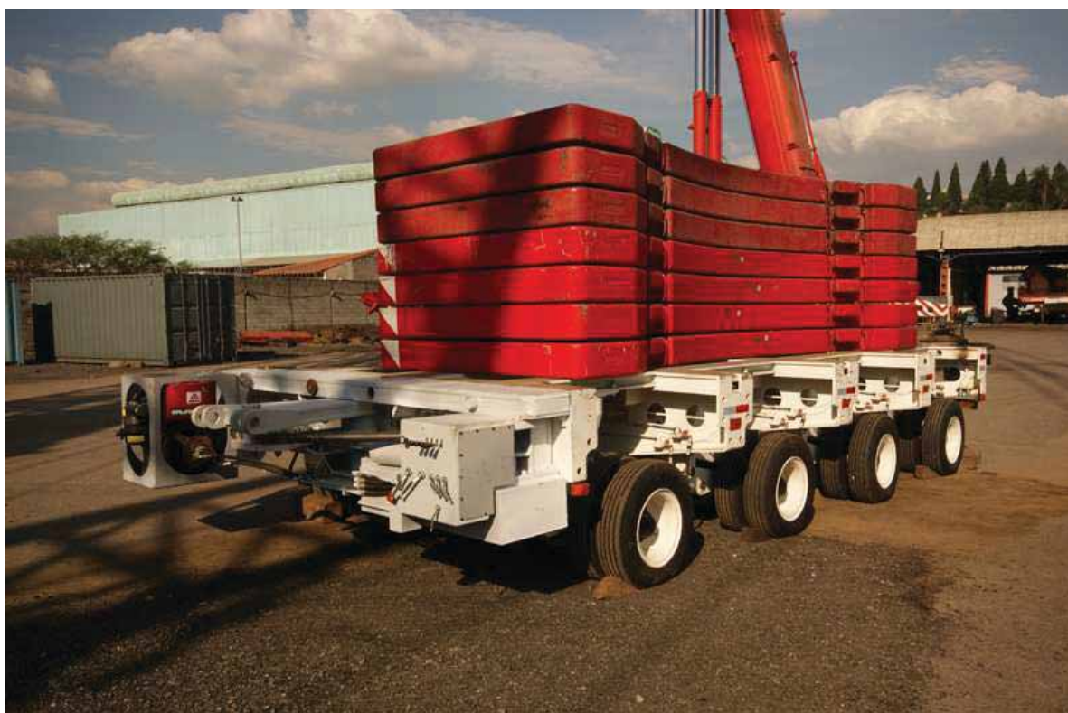
FIGURA 16 – Teste de carga da RB/LE-001 com 120 toneladas (Metalúrgica Guará, 2010)
