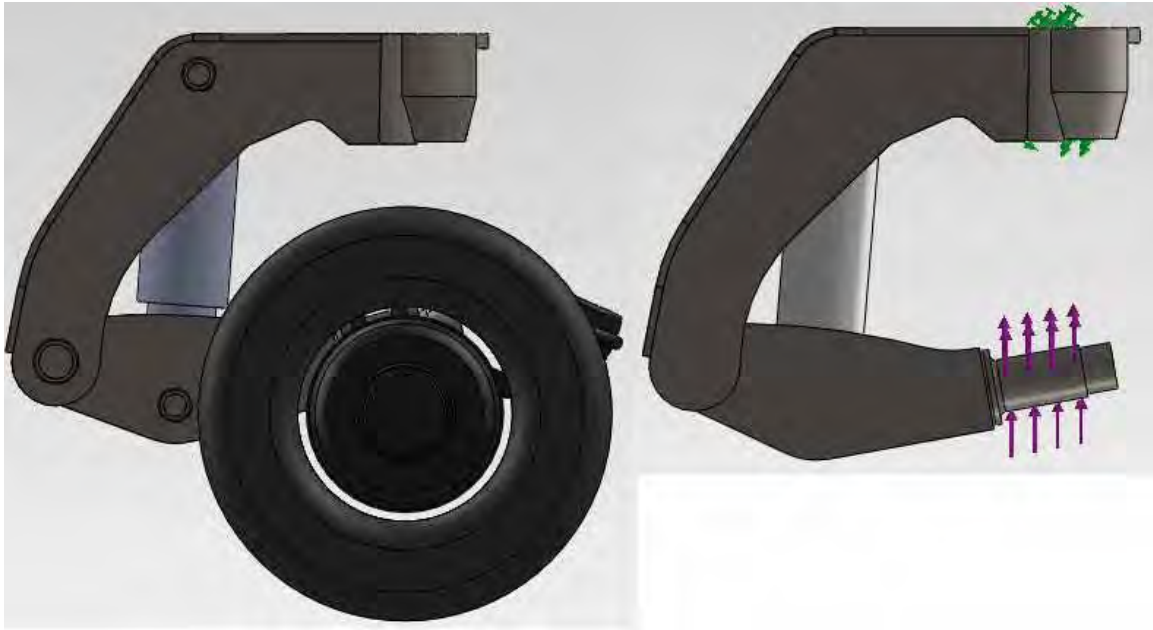
FIGURA 28 – Ponto de aplicação de esforços no conjunto da suspensão
