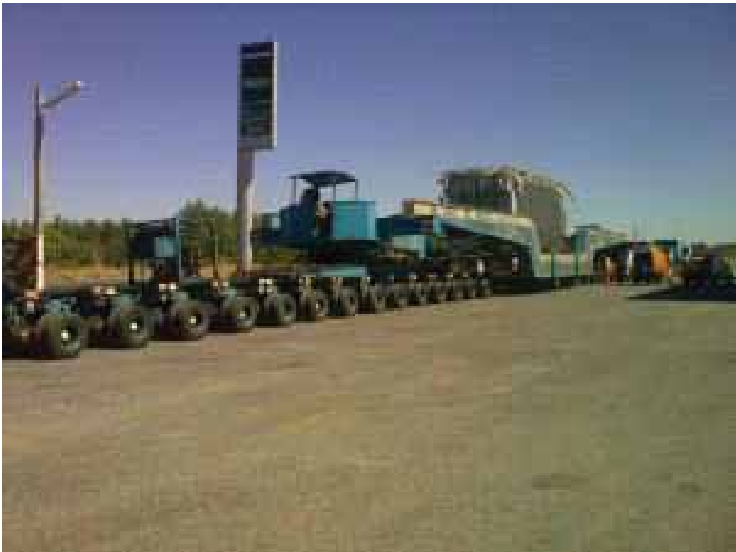
FIGURA 2 – Transporte de Transformador de 400 toneladas na BR-060. (Fonte: PORTAL 730, 16/06/2010)
