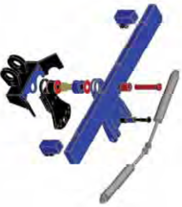
Cabeceira comando hidráulico
