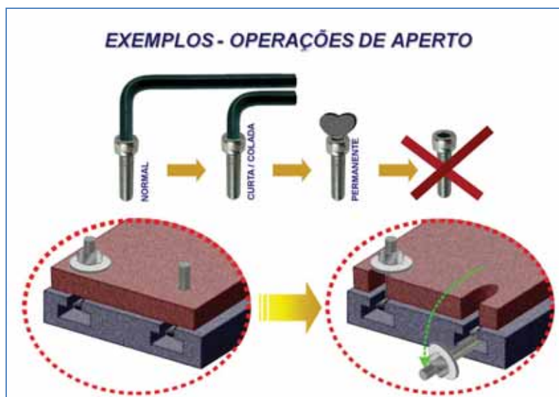
Figura 22 – Exemplo de Operações de aperto, utilizando a metodologia ECRS (SHINGO, 1985)
