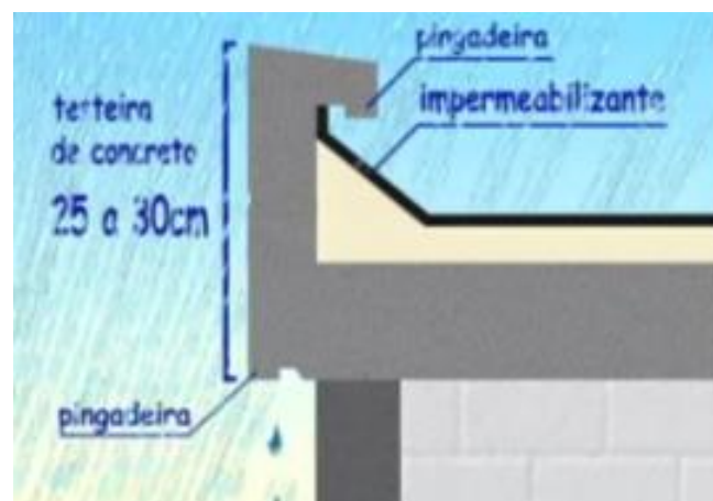
Figura 40 – Pingadeiras de proteção da laje impermeabilizada
