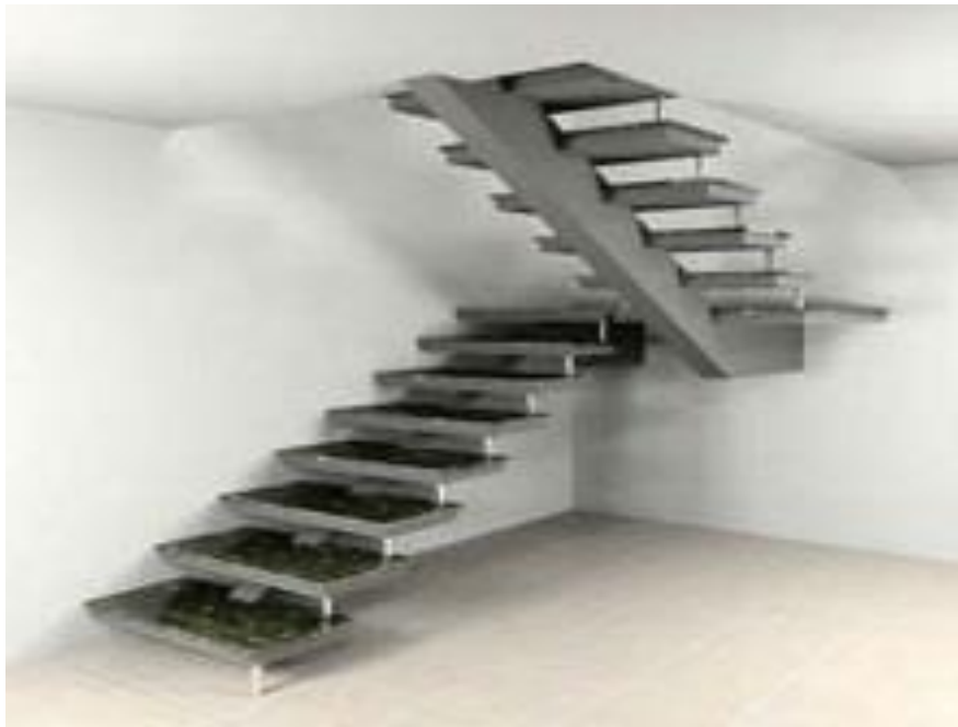
Figura 44 – Escada em U
