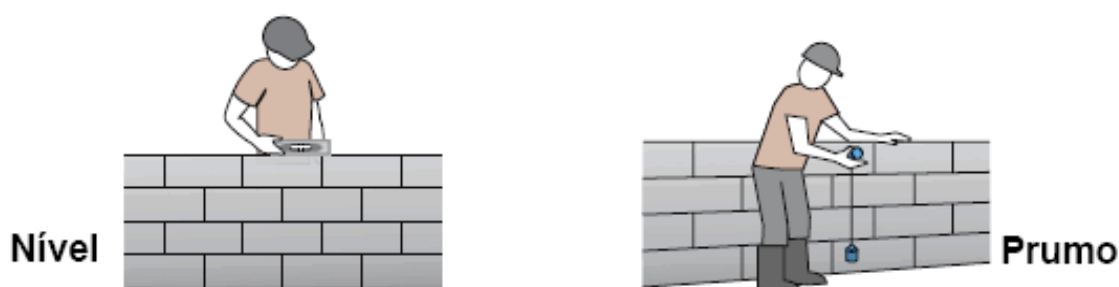
Figura 30 – Verificação de nível e prumo da parede
