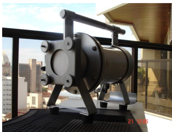
Figura 3 – Aparelho portátil HANDI-VOL instalado na sacada de um apartamento no centro da cidade de Araraquara (PERON, 2006).
