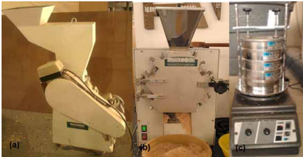
Figura 5 – (a) Picador de madeira, (b) Moinho e (c) Agitador de peneiras.
