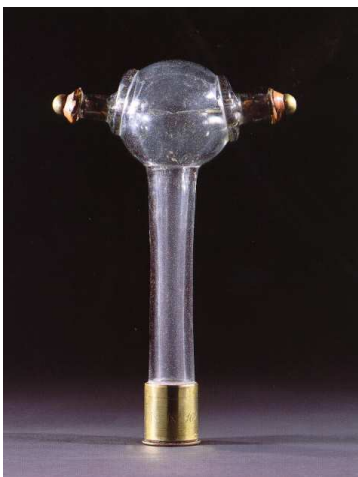
Figura 3– Voltâmetro utilizado por Nicholson e Carlisle na eletrólise da água (museu.fis.uc.pt)
