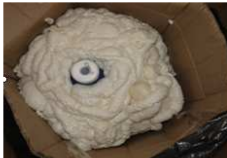
Figura 3.5- Espuma expansiva de poliuretano entre o papelão e o galão (GOMES, 2013).
