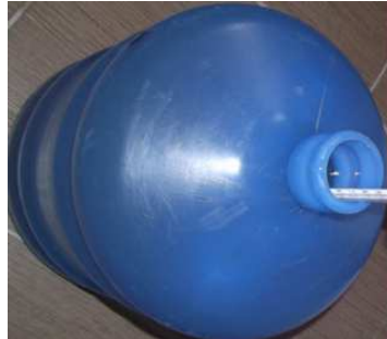
Figura 3.7 - Medição da temperatura interna do reservatório térmico na posição vertical (GOMES, 2013).
