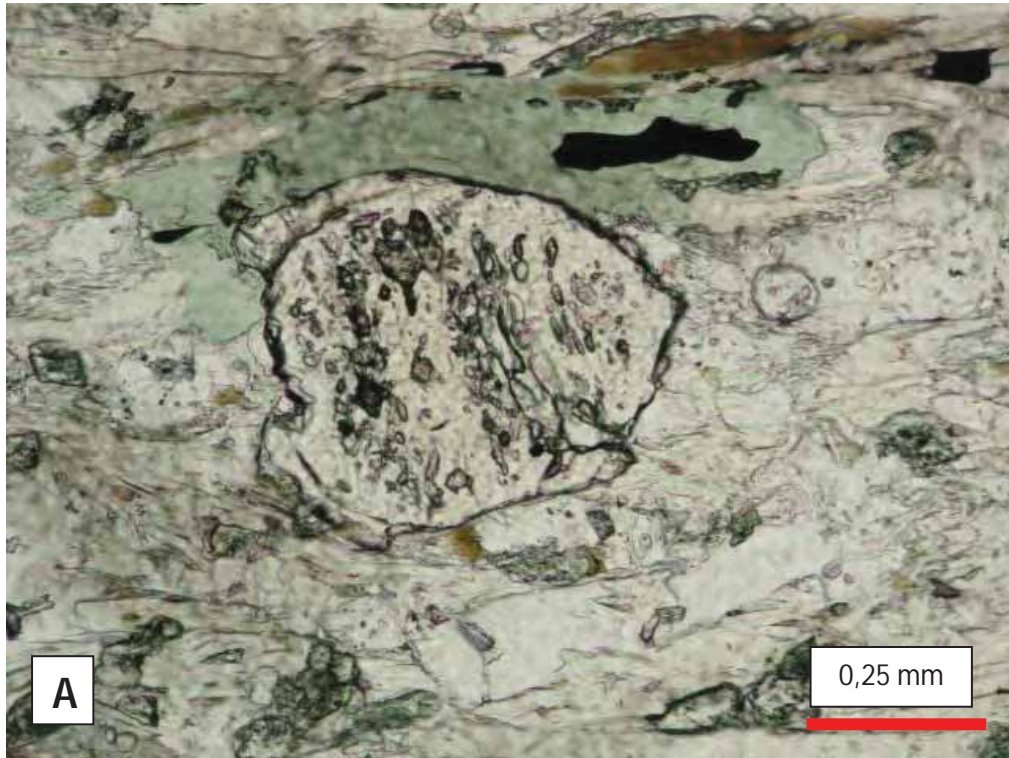
Figura 3 – Fotomicrografias de clorita-biotita-pirita-quartzo-muscovita xisto, com detalhe para cristal de granada poiquilítica, com inclusões de quartzo.
