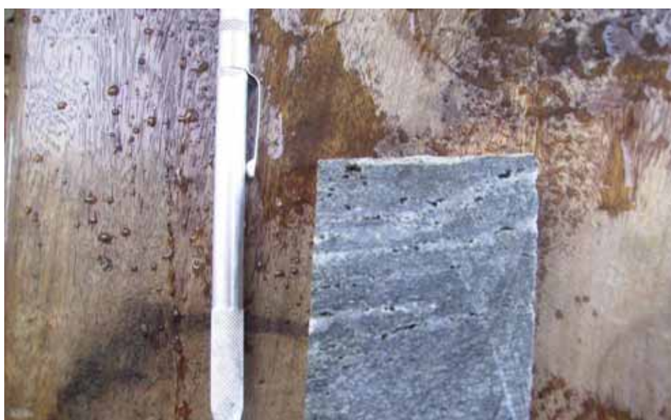
Figura 6.4 – Intervalalo amostrado de testemunho de sondagem de epidoto-anfibólio-biotita gnaisse muscovitizado(Furo HN-01, 321,57m de profundidade)
