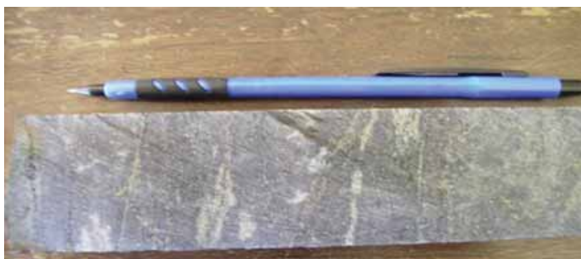
Figura 6.14 – Intervalo amostrado de testemunho de sondagem de granada-clorita-epidoto-biotita gnaisse (Furo SU-23, 125,90m de profundidade)
