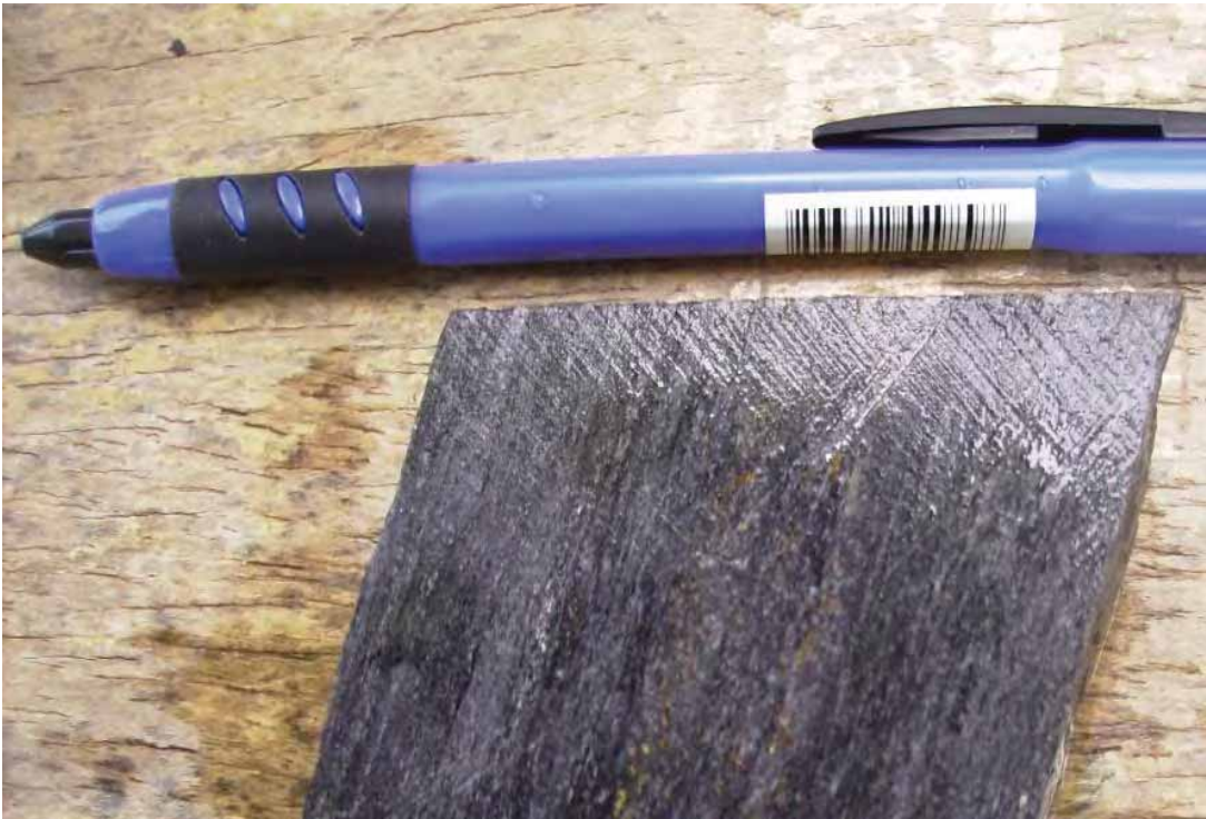
Figura 6.6 – Intervalo amostrado de testemunho de sondagem de muscovita-biotita gnaiss (metagranito)(Furo HN-01, 330,32m de profundidade)
