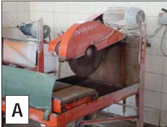
Figura 3.2 – (A) Serra de disco diamantado; (B) Politriz de Bancada; (C) Microscópio binocular da Zeiss – Axioscop 40
