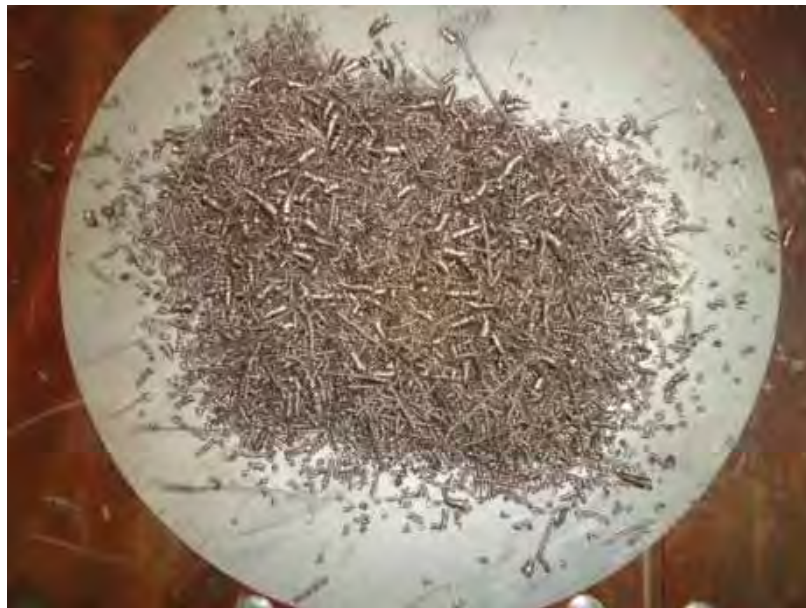
Figura 6 - Cavacos em lascas da carepa retirada do tubo de FoFo.
