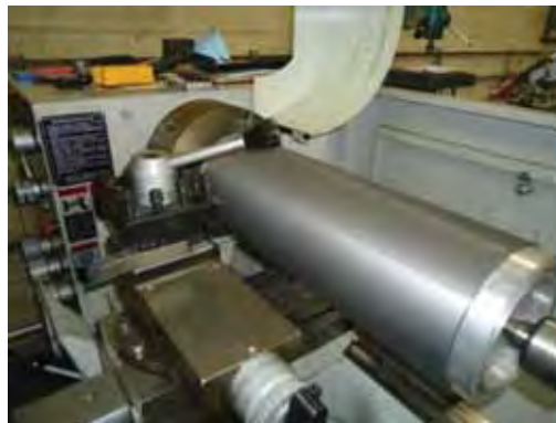
Figura 18 - Tubo de ferro fundido para o Início dos ensaios.
