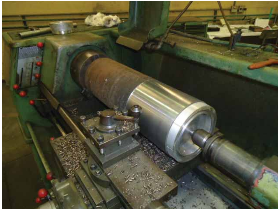
Figura 15 - Tubo de ferro fundido preparado para ser ensaiado.
