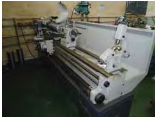
Figura 13 - Torno Nd 250 Nodus da marca Nardini preparado para realização dos ensaios.
