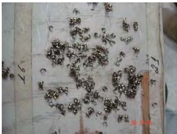
Figura 9 – Cavacos em lascas aço inoxidável.
