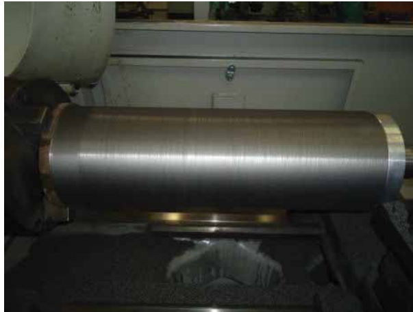
Figura 7 - Cavacos quebradiços do FoFo.
