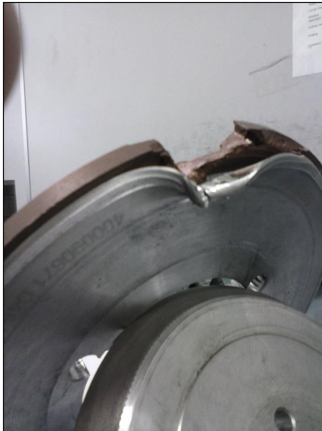
Figura 9 - Rebolo danificado devido a choque
