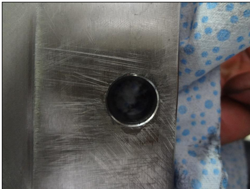
Figura 11 - Fixação de spindle danificada devido a choque
