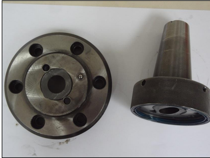
Figura 10 - Mandril danificado devido a choque
