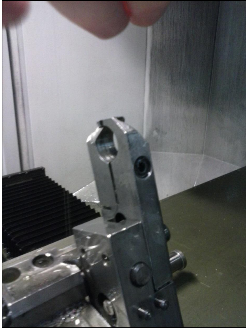
Figura 12 - Porta bucha danificado devido a choque
