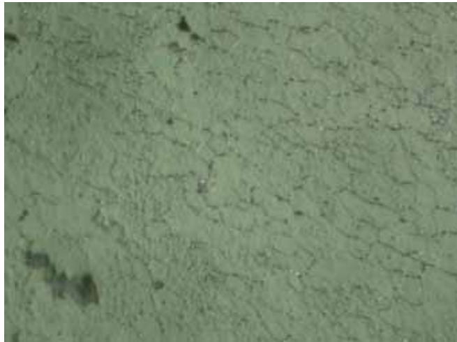
Figura 25 – Micrografia da amostra C do ataque de 240 segundos, aumento de 1000 vezes.
