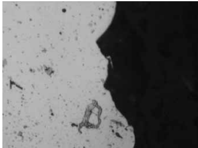
Figura 11 – Micrografia da amostra D do ataque de 30 segundos, aumento de 1000 vezes.
