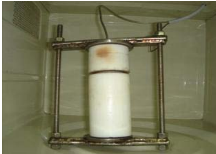
Figura 10 – Suporte metálico com o vaso digestor montado.
