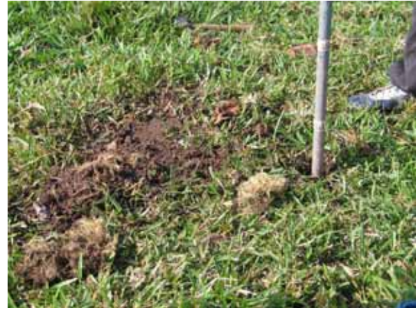
Foto 8 – Sondagem a trado 01 com presença de resíduos
