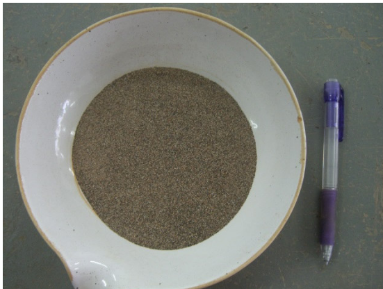
Figura 13 - Material retido na peneira de 0,075 mm
