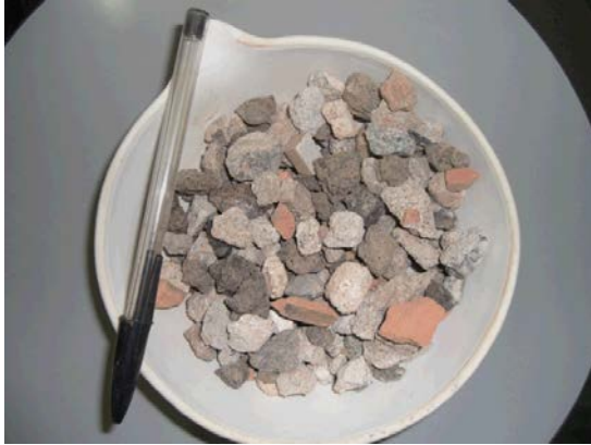
Figura 9 - Material retido na peneira de 9,5 mm
