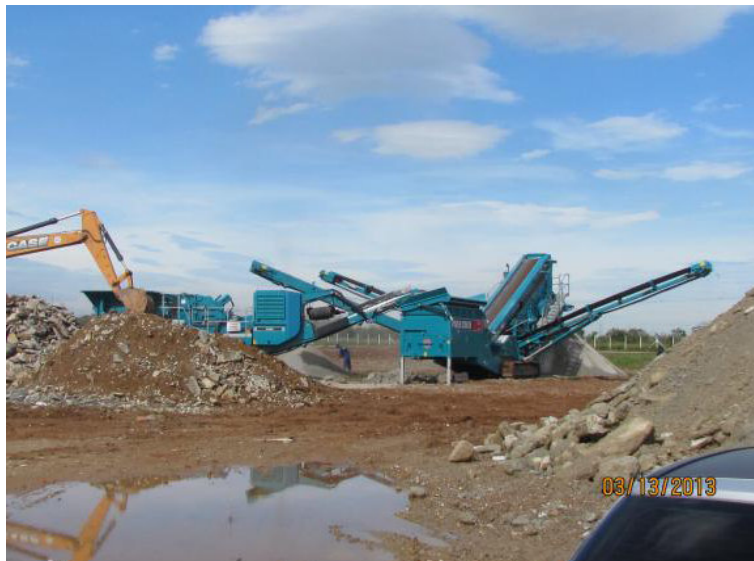
Figura 18 - Usina móvel para produção de agregados de RCD. Fonte: OLIVEIRA (2013).
