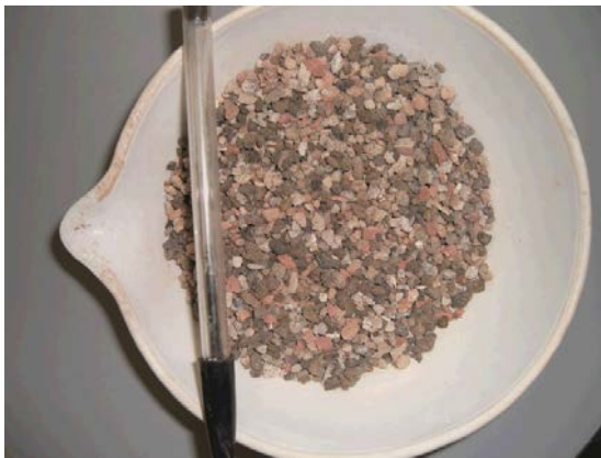
Figura 11 - Material retido na peneira de 2,0 mm
