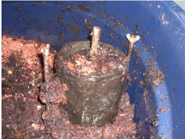
Figura 2 – Corpo de prova para ensaio CBR durante o processo de envolvimento no pó de serra. Fonte: Autora.
