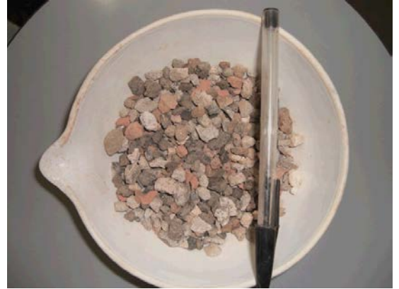
Figura 10 - Material retido na peneira de 4,8 mm
