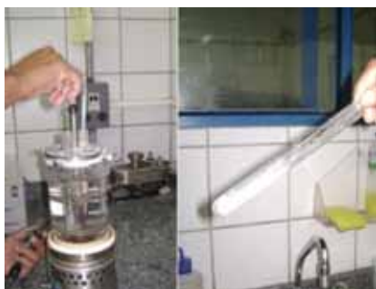
Figura 28 – Realização do teste de Gel Time.
