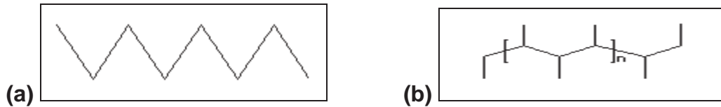
Figura 3 - Estruturas dos polímeros lineares: (a) linear e (b) linear ramificada.
