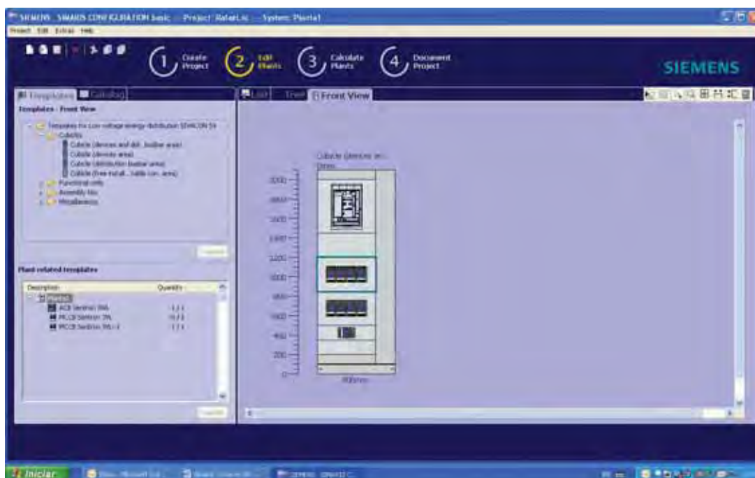
Figura 13 – Inserção de equipamentos no painel Sivacon S4.
