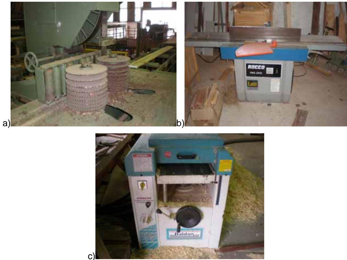
Figura 13 – Máquinas para beneficiamento da madeira. a) Resserra ; b) Desempenadeira ; c)Desengrossadeira.
