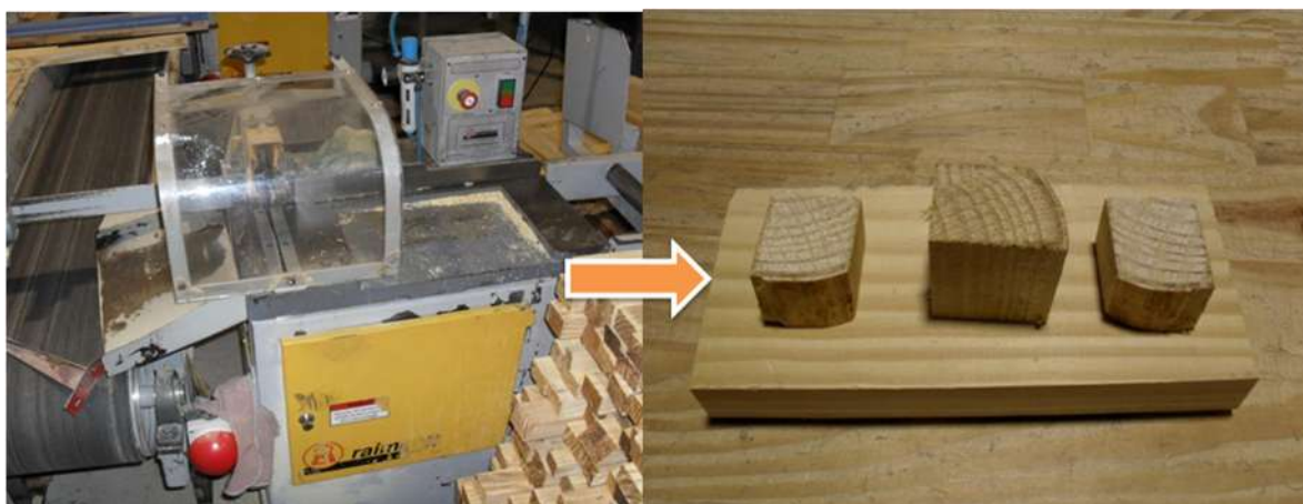
Figura 4: Máquina Destopadeira e resíduos de destopo
