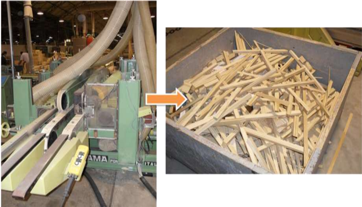
Figura 5: Perfiladeira e resíduos gerados pela mesma.
