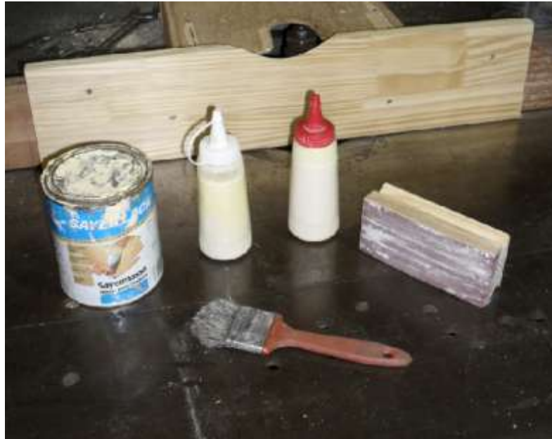
Figura 7: Colas, pincel e lixa utilizados na produção dos painéis.
