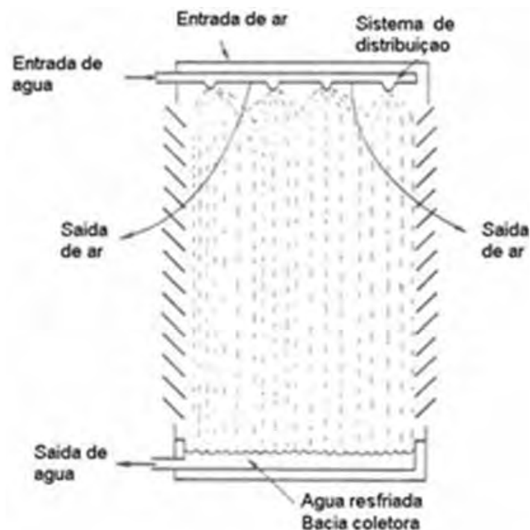
Figura 22: Torre de resfriamento atmosférica
