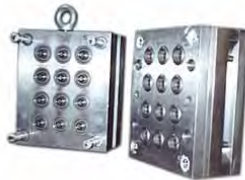
Figura 5 – Imagem das duas partes de um molde de injeção
