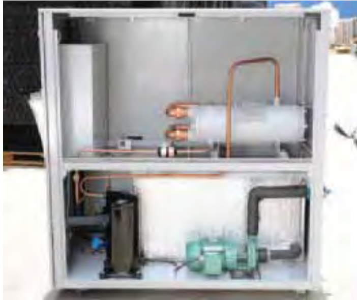
Figura 40 – Parte interna da unidade de água gelada usada no sistema. Pode-se ver o trocador de calor, o compressor e a bomba.
