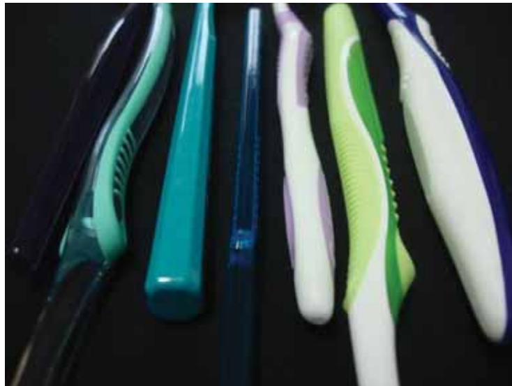
Figura 29 – Alguns cabos de escovas de dente de diversos fabricantes, alguns feitos com base de polipropileno e outros de copoliéster.
