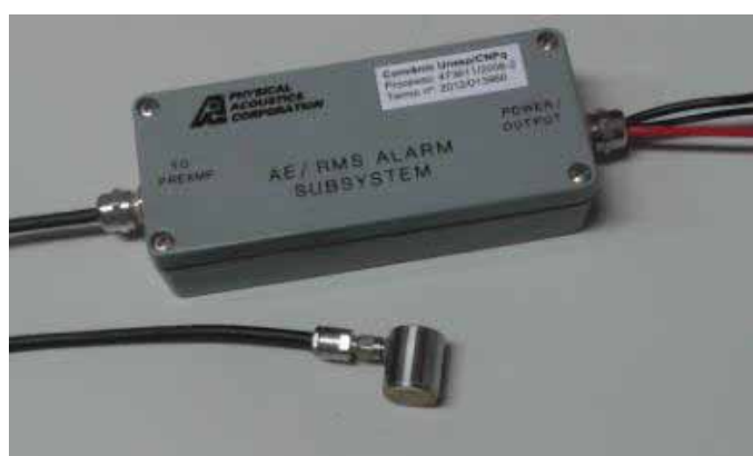
Figura 16: um sistema de captação de emissão acústica da marca PHYSICAL ACOUSTICS CORPORATION
