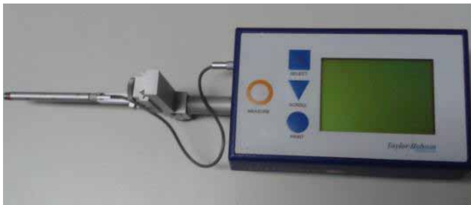
Figura 15: Rugosímetro da marca TAYLOR HOBSON, modelo Surtronic 25+
