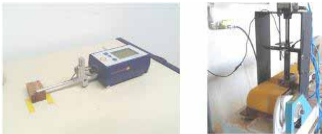
Figura 10: (a) Rugosímetro utilizado para determinar a rugosidade das superfícies lixadas de Corymbia citriodora . (b) Lixadeira plana Marca Baldan modelo LFH-2, com sistema automático de avanço
