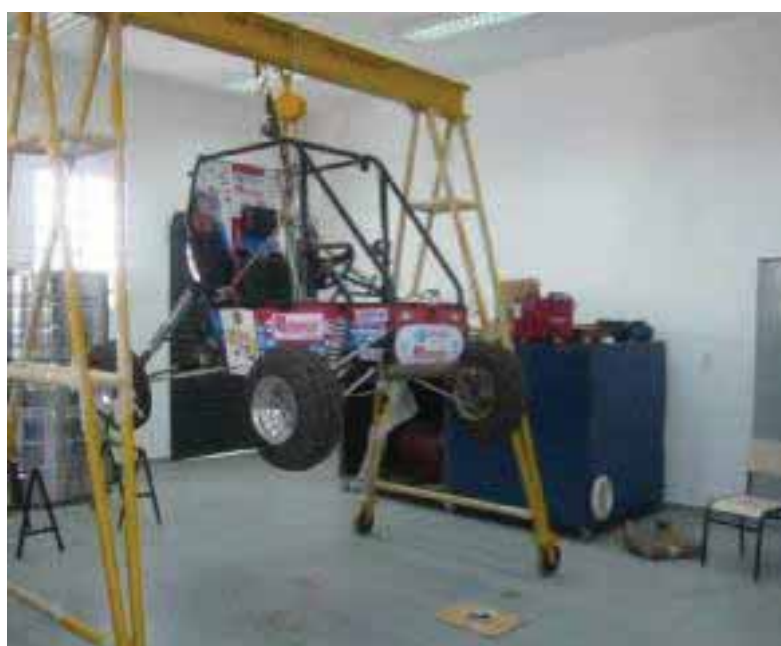
Figura 11 - Estrutura para ensaio drop test
