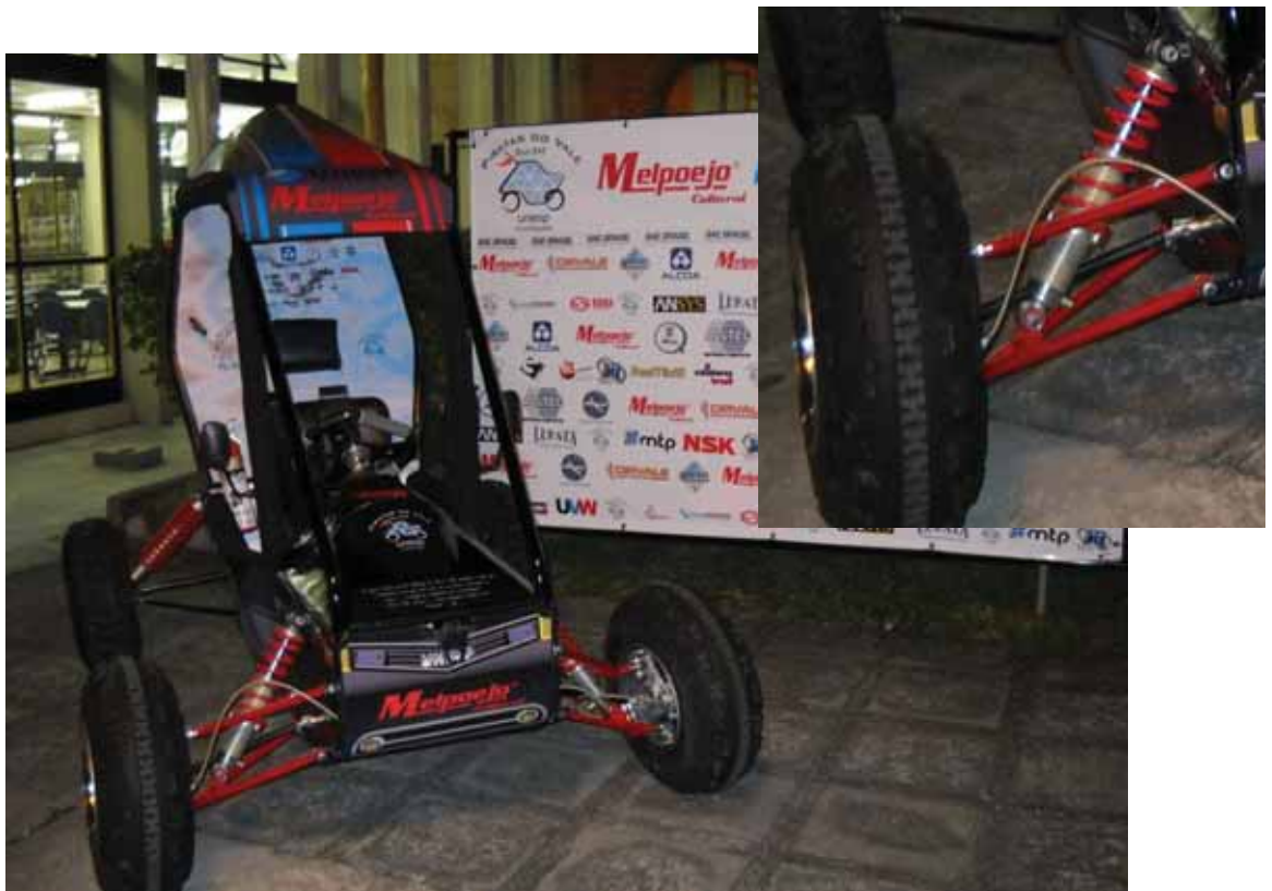
Figura 3 - Suspensão Double Wishbone
