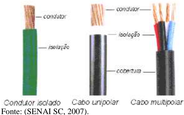
Figura 25 - Tipos de cabos elétricos de potência em baixa tensão.
