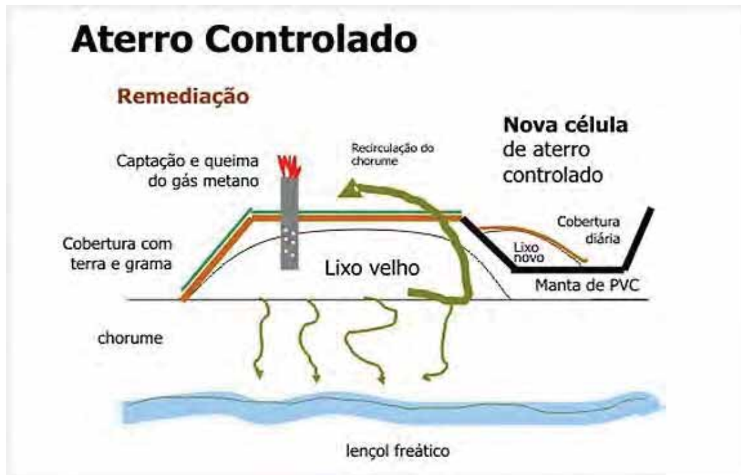
Figura 13: Aterro controlado - esquema. (Fonte: Google).
