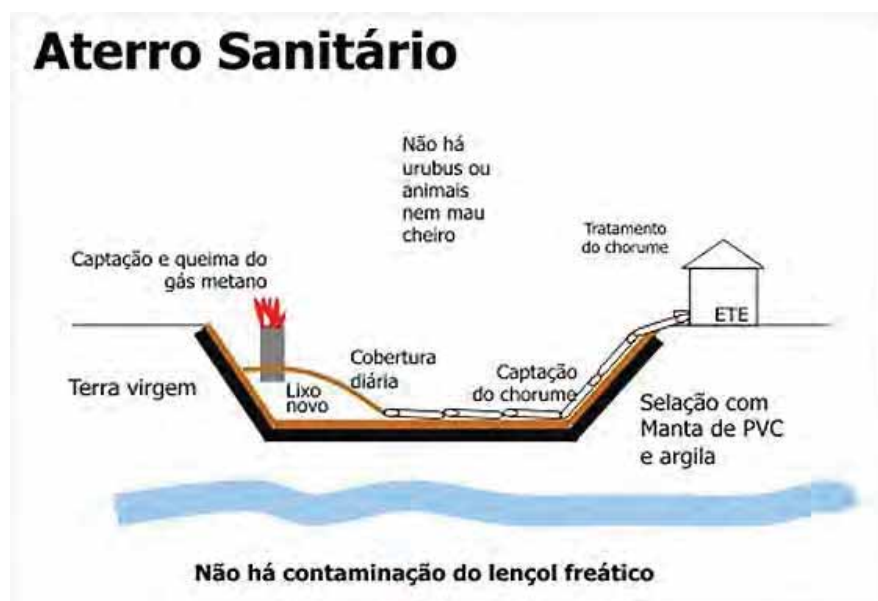
Figura 12: Aterro sanitário - esquema. (Fonte: Google)
