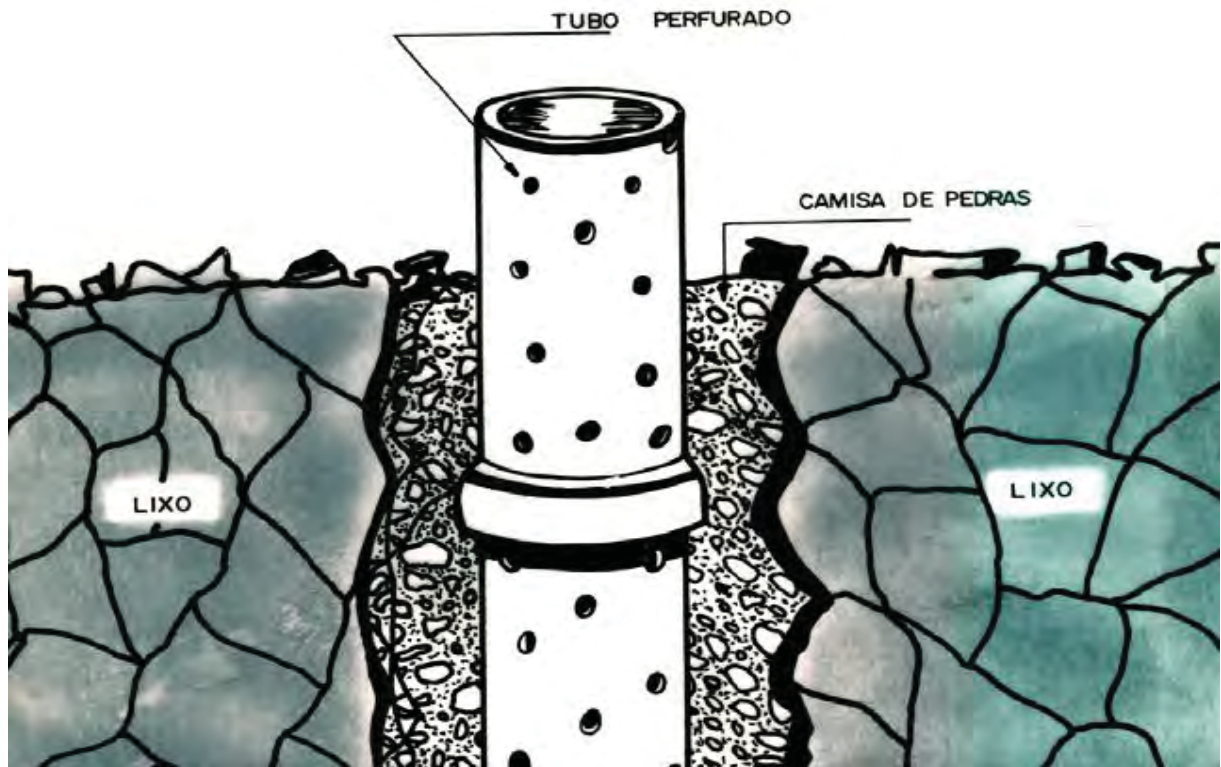
Figura 22: Detalhe da dissipação. (Fonte: MINTER/CNDU/CETESB, 1979)
