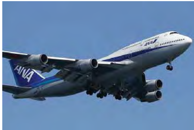
Figura 10- Configuração Roda Duplo Duplo Tandem (Boeing 747) Fonte: Kazuchika Naya.
