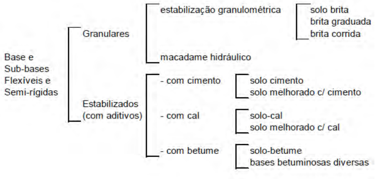
Figura 4 - Classificação das bases e sub bases flexíveis. Fonte: Manual de Pavimentação DNIT (2006).
