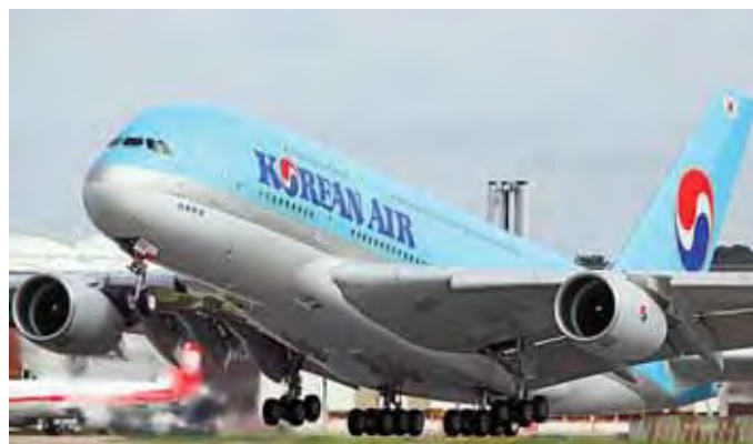
Figura 11 - Trem de Pouso de Roda Triplo Duplo Tandem (Airbus A380) Fonte: Lars Hentschel.
