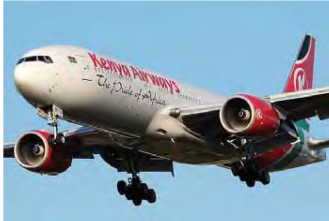
Figura 9 - Configuração Roda Triplo Tandem (Boeing 777) Fonte: Phil Broad
