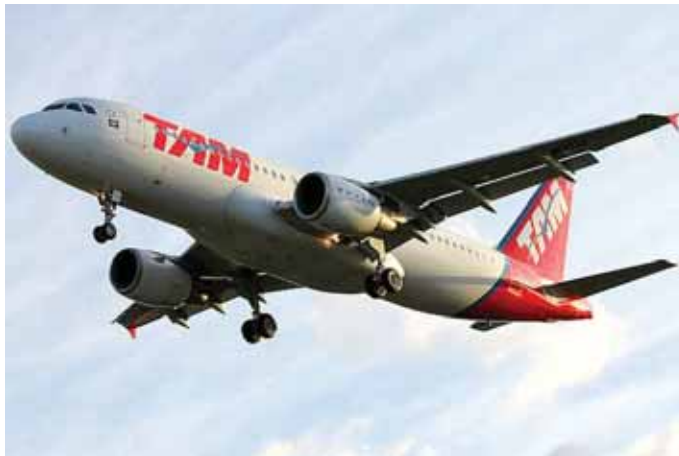
Figura 7 - Configuração Roda Dupla (Airbus A320). Fonte: Roger S. Rodrigues.
