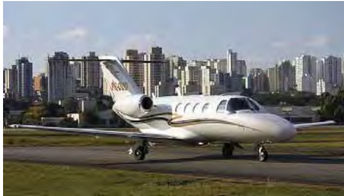
Figura 6 - Configuração Roda Simples (Cessna Citation). Fonte: Tadeu Primo.
