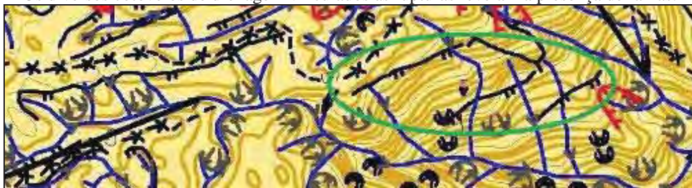
Figura 12 - Exemplos de setores onde as rupturas topográficas perpassam canais de primeira e segunda ordem. Os diversos cotovelos de drenagem vinculados às rupturas revelam a presença de falhas.
