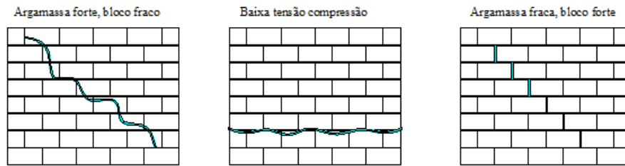
Figura 5 – Tipo de ruptura por carga horizontal.
