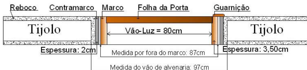
Figura 30 – Exemplo de contramarco de portas de madeira (fonte: site Esquadrias Primos).
