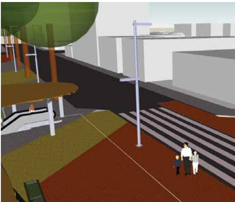
Figura 75: Vista do poste de duas luminárias. Uma em nível mais baixo que as árvores para iluminar a calçada e outra para a rua, de dimensão mais alta.
