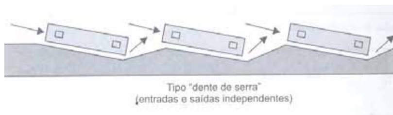
Figura 50: Plataformas no formato "dente de serra" no qual as entradas e saídas dos ônibus são independentes agilizando a velocidade de embarque e desembarque. Fonte: FERRAZ e TORRES (2006)
