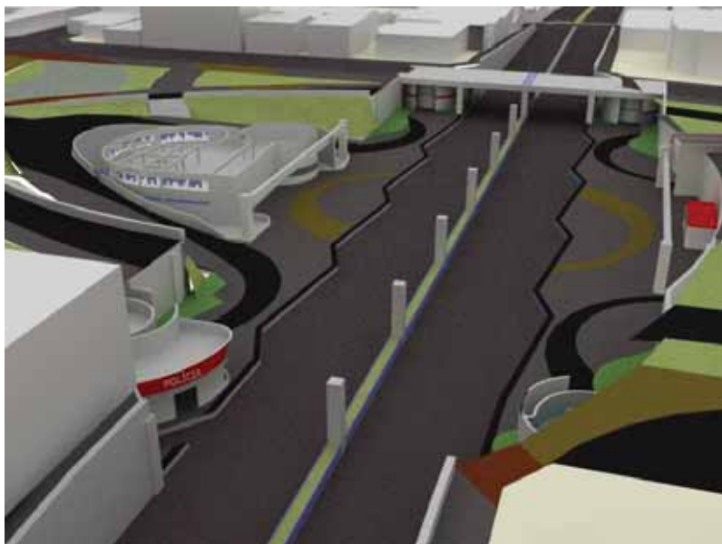
Figura 45: Estrutura. O muro de arrimo cerca toda a parte rebaixada da via e do terminal. No centro uma fileira de pilares que sustenta o meio do vão. Dois pilares e uma viga no centro suportam o vão em frente às bilheterias.
