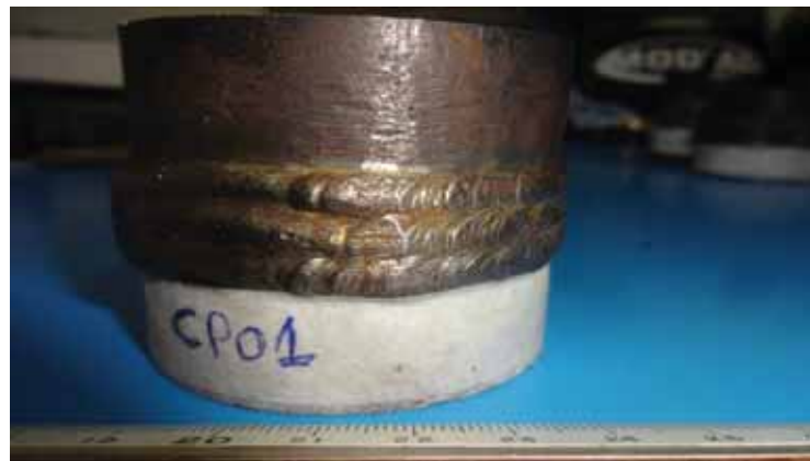
Figura 17-Detalhe do cordão de solda da amostra 1
