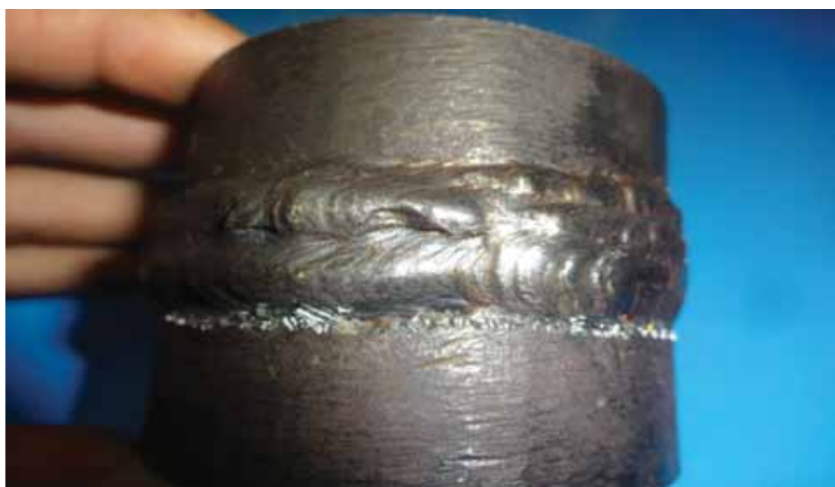
Figura 23- Detalhe do cordão de solda 4
