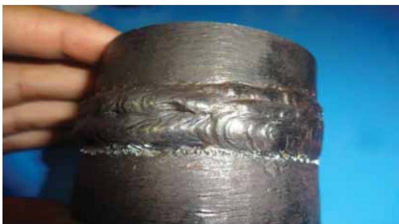
Figura 30- Corpo de prova após corte com a serra de fita
