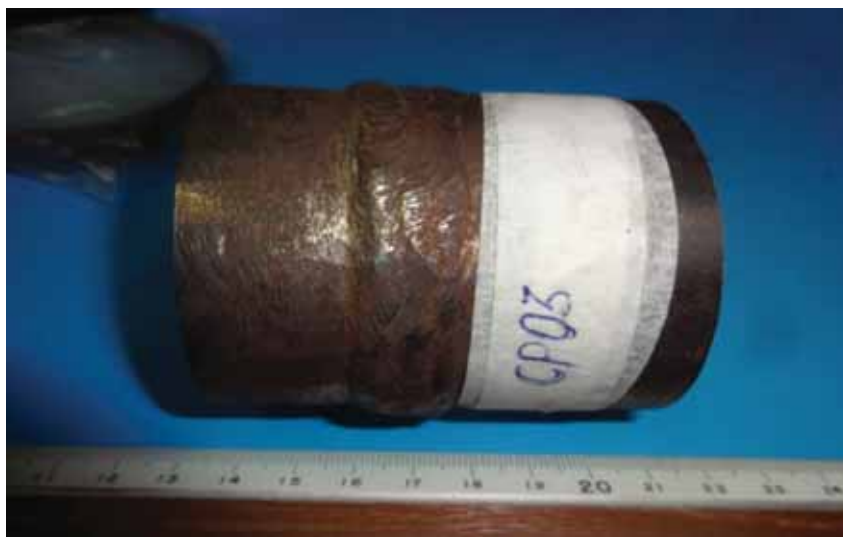
Figura 21- Detalhe do cordão de solda da amostra 3
