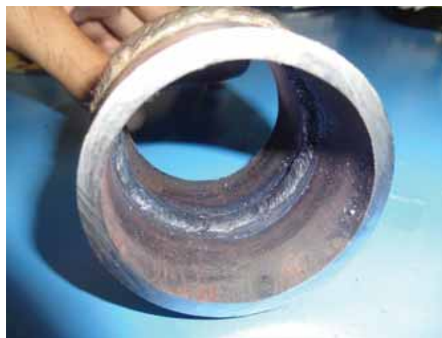
Figura 18- Detalhe do passe de raiz na parede interna ao tubo
