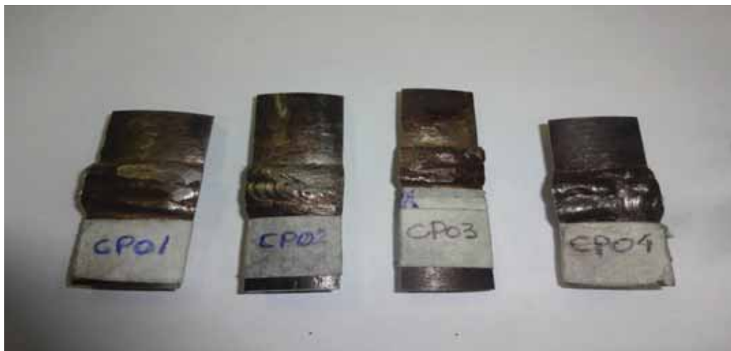
Figura 31- Corpo de prova após corte com serra vertical
