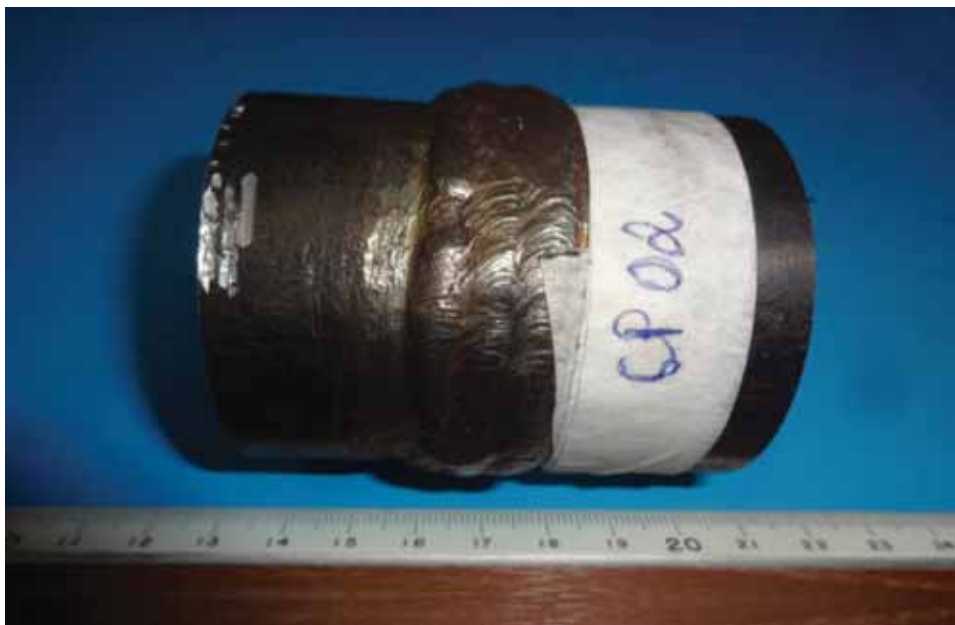
Figura 19- Detalhe do cordão de solda da amostra “2”
