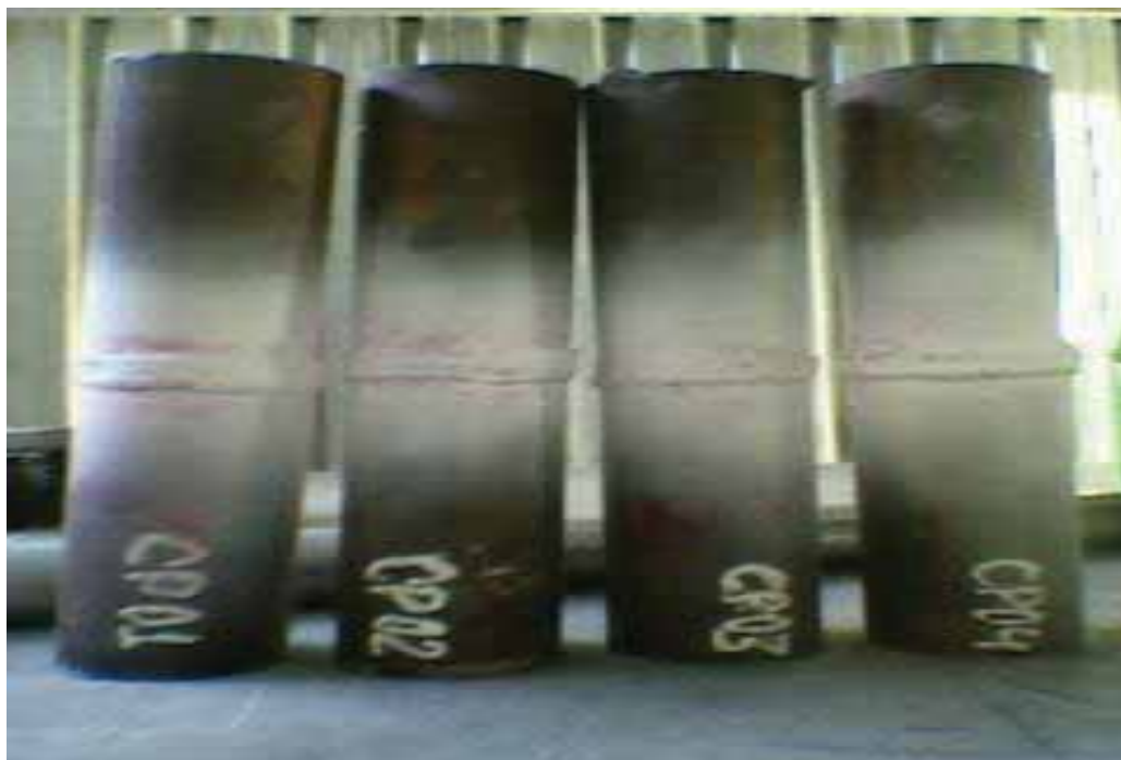
Figura 25- Aplicação de líquido penetrante nos passes de raiz
