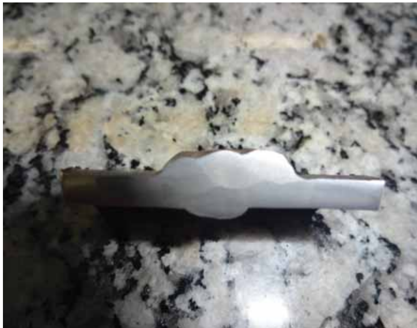
Figura 33 – Amostras após aplicação do nital 10%
