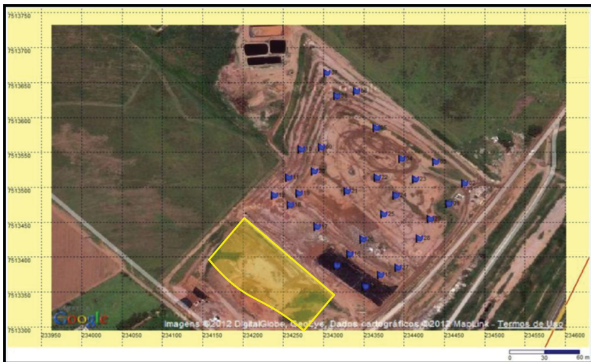
Figura 13: Imagem do aterro sanitário de Rio Claro - SP com a localização dos drenos de gás e com a nova área de disposição de resíduos destacada em amarelo.
