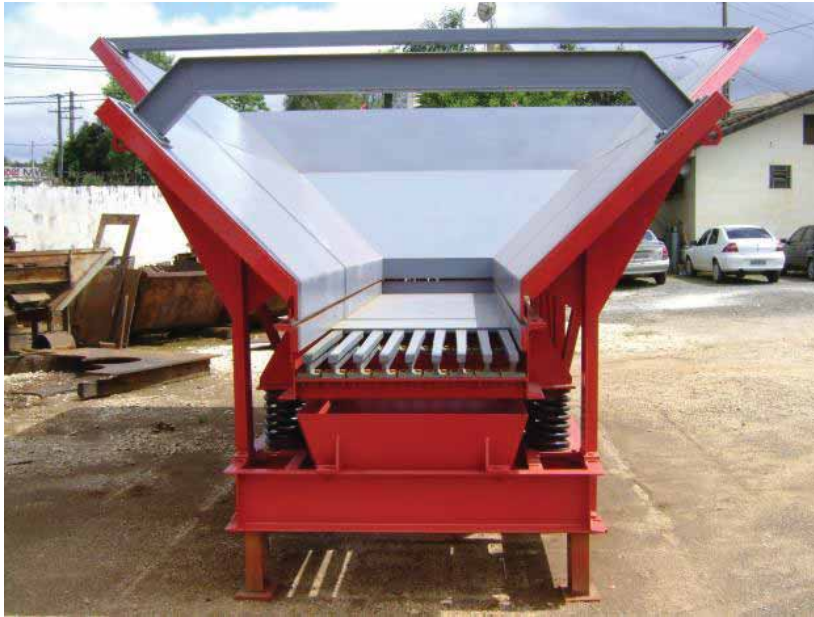
Figura 4 – Alimentador Vibratório utilizado no Processo de Reciclagem dos RCD
