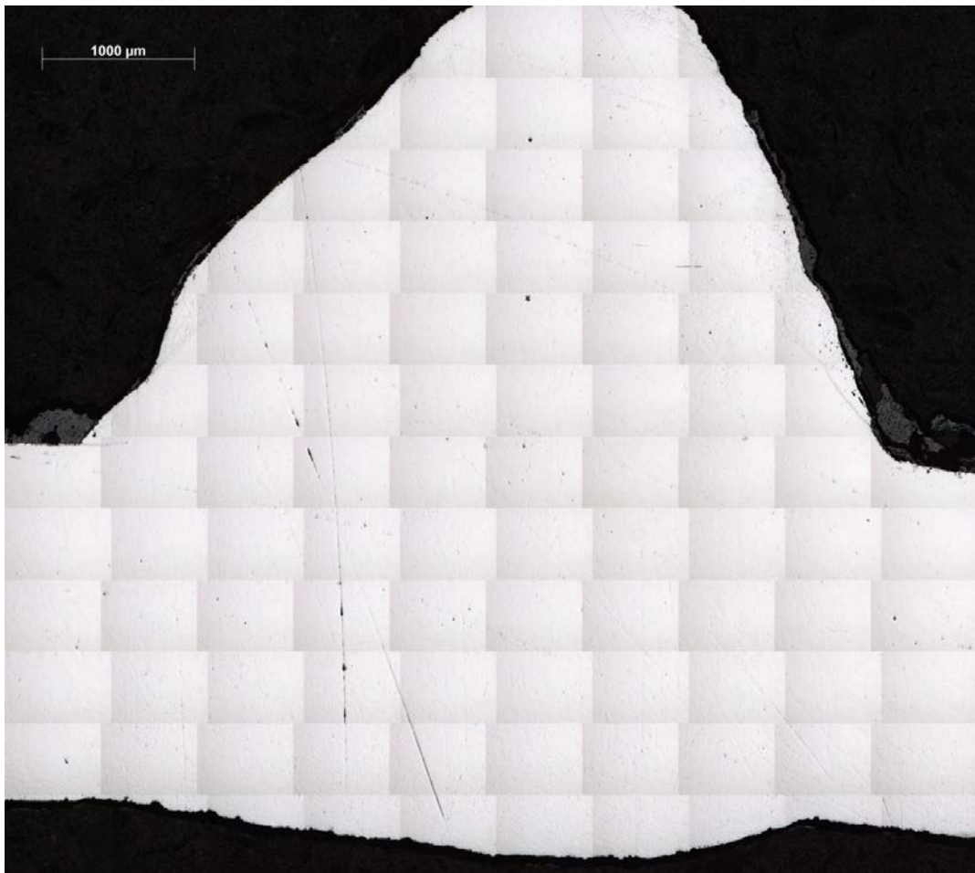
Figura 20 - Mosaico da amostra C4, com quatro retrabalhos de solda, mostrando a área de solda, formado a partir de fotos com ampliação de duzentas vezes.
