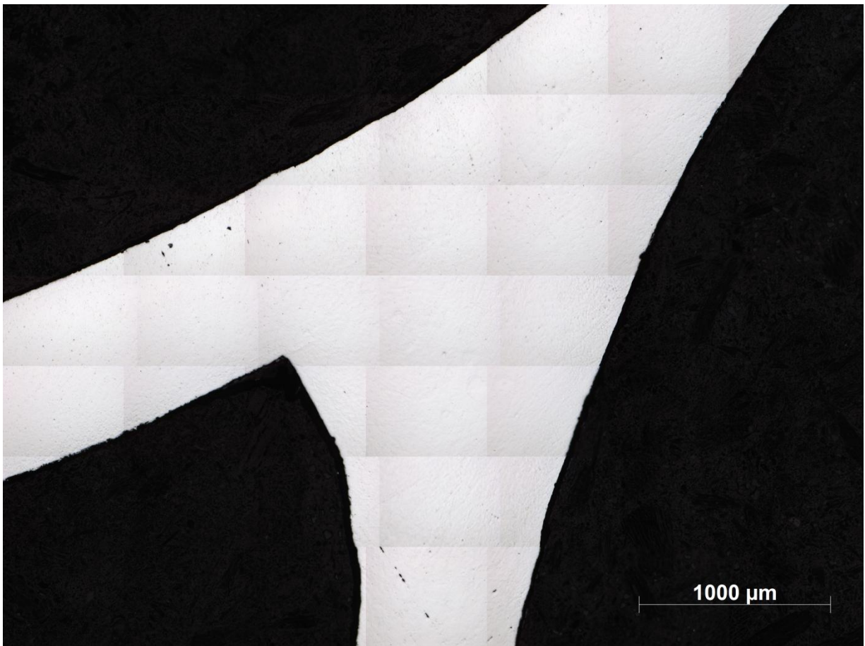
Figura 15 - Mosaico da amostra C1-1, com solda original, mostrando tanto a área de solda quanto parte do metal base.
