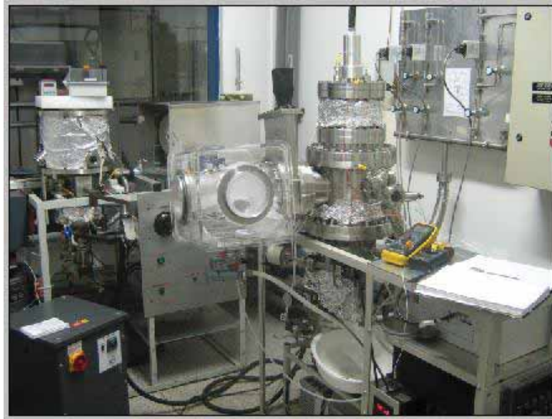
Figura 6: controlador de temperatura interna acoplado ao sistema de sputtering (LFS).
