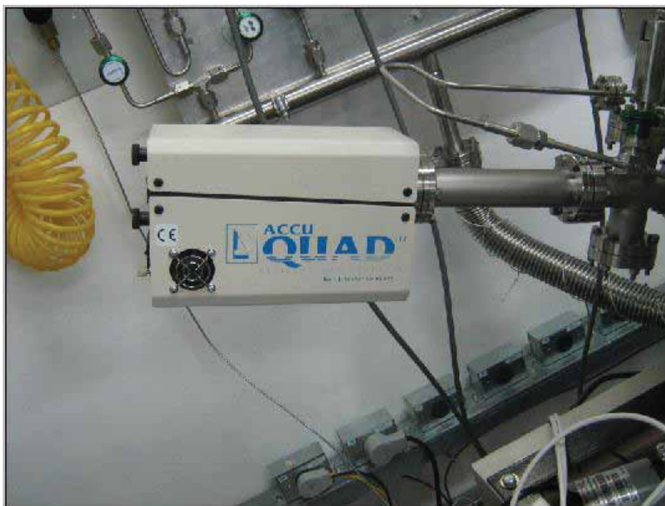
Figura 5: Analizador de Gases Residuais (RGA), acoplado ao sistema de sputtering (LFS).
