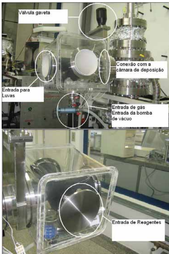
Figura 7: (a) Entradas em aço inox da glove box com destaque para as suas respectivas funções no sistema (b) entrada de reagentes e amostras (LFS).
