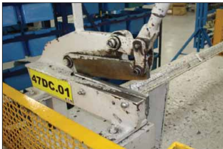
Figura 24 – Guilhotina de corte de protetores plásticos espiralados
