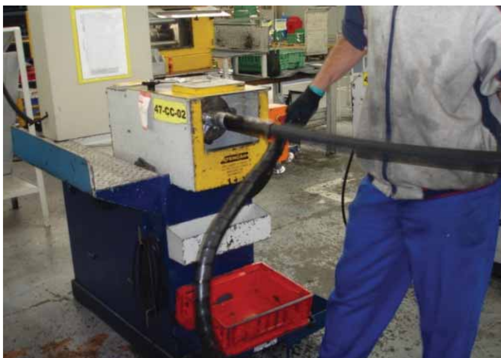
Figura 25 – Aplicação do protetor com a mangueira rotacionando e uma ferramenta que enrola o protetor plástico na mangueira
