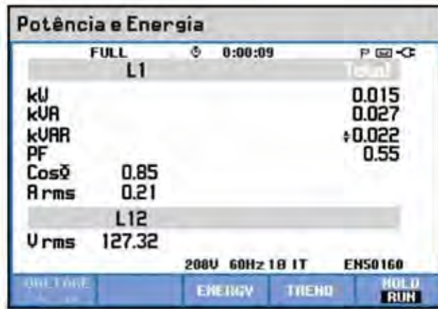
Figura 35 – Valores de Potência e Energia na LFC 15W Fonte: Própria
