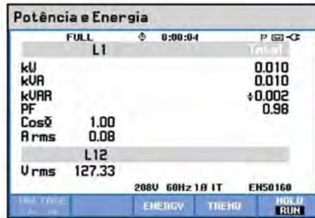
Figura 43 – Valores de Potência e Energia na LED 10W Fonte: Própria
