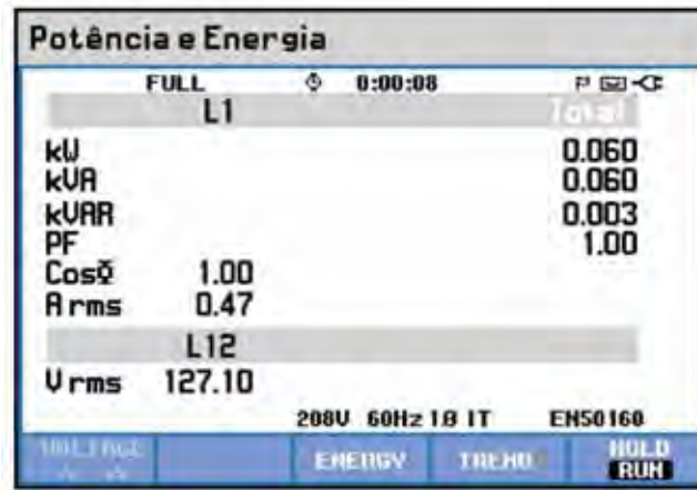
Figura 31 – Valores de Potência e Energia na LI 60W Fonte: Própria
