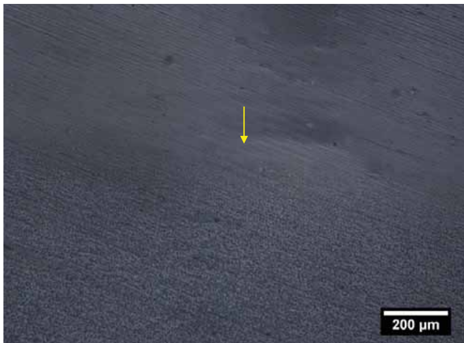
Figura 30 - Micrografia 50x da secção transversal da resina FF 1:1 homogeneizada com a ponteira ultrassônica.
