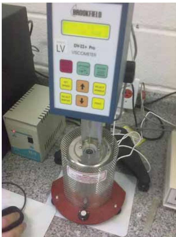
Figura 18 - Viscosímetro Brookfield, modelo RV DV-II + Pro utilizado.
