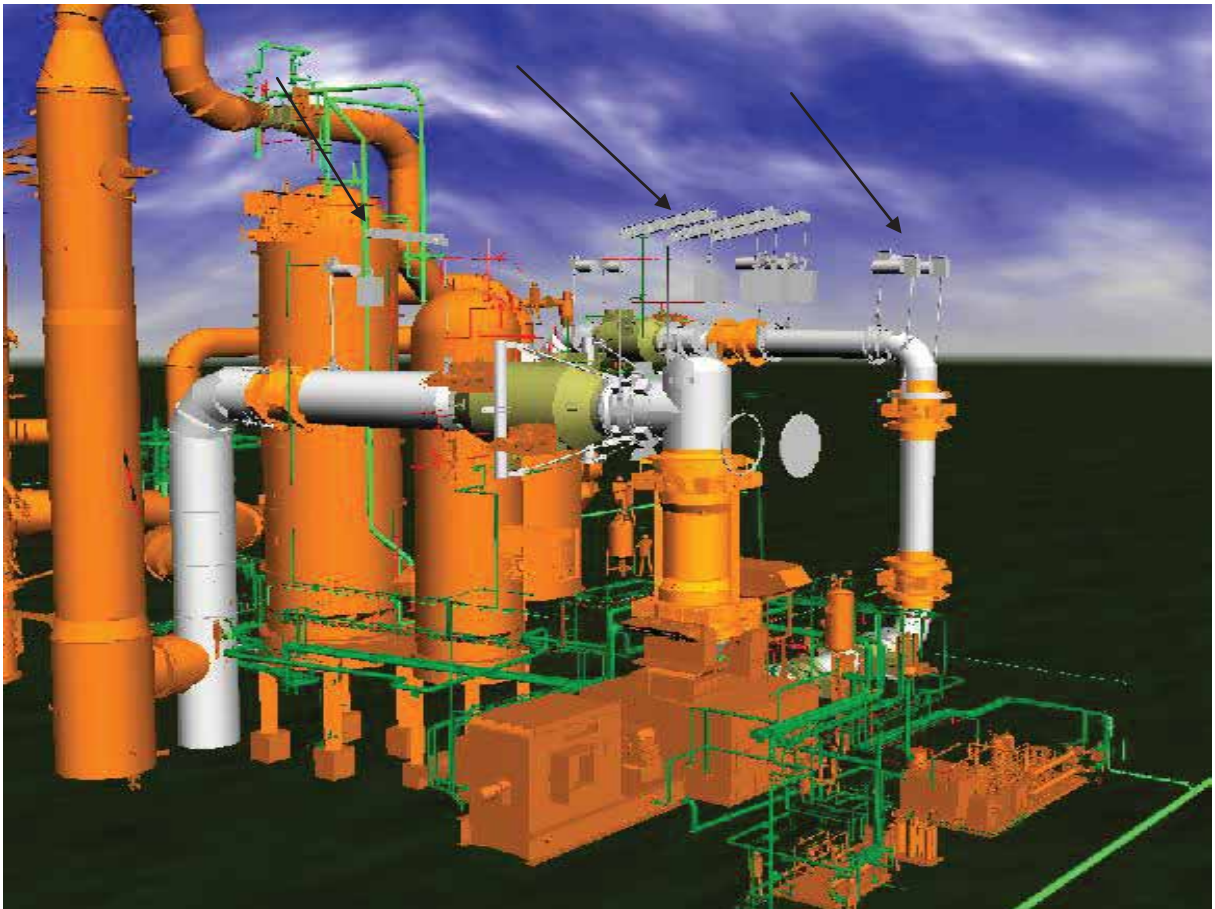
Figura 12 – Maquete da Unidade FCC (POTENCIAL ENGENHARIA S.A.)
