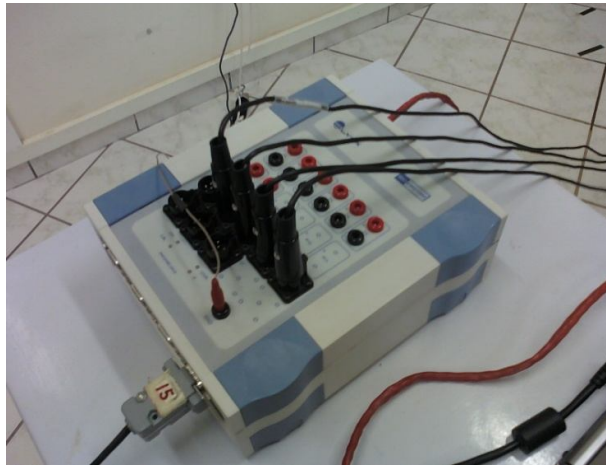
Figura 3. Módulo condicionador de sinais analógicos, modelo Bio EMG 1000, marca Lynx®, com os cabos dos eletrodos conectados.
