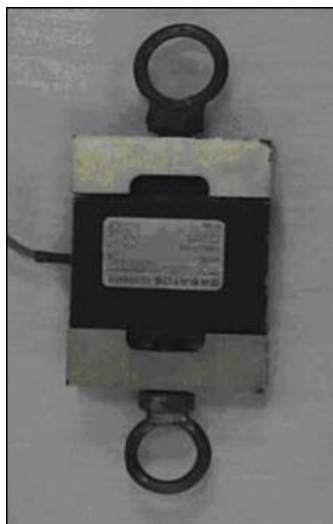
Figura 2. Célula de carga modelo MM da marca Kratos® Dinamômetros utilizada para monitorar a força muscular.
