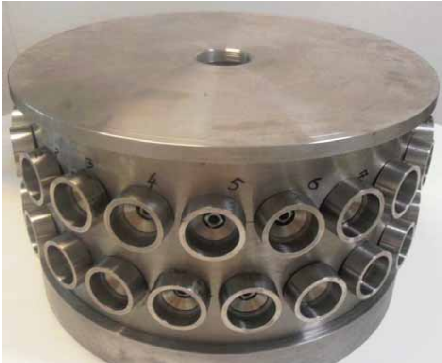
Figura 4. Montagem da câmara externa: O anel externo, com sua tampa, forma a câmara externa que faz a exaustão da atmosfera não inalada pelos animais e do ar que exalam, através de aspiração por uma abertura central na tampa da câmara do equipamento.
