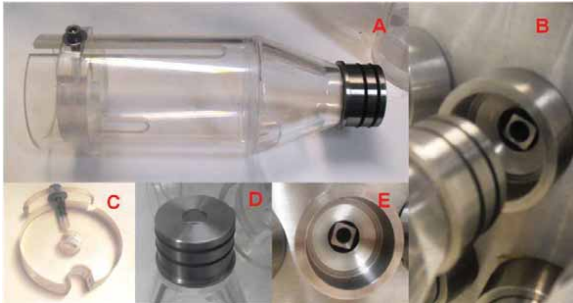
Figura 5. Contentor e seu acoplamento ao sistema. A) corpo do contentor em que se vê o acoplamento metálico, uma ranhura superior para ajustar a tampa posterior ao tamanho do animal e permitir acesso ao seu dorso, e uma abertura inferior para escoar fezes e urina durante a exposição. B) detalhe do acoplamento do contentor à câmara, C) detalhe da tampa de acrílico com a trava para fixar o seu posicionamento e uma ranhura na parte oposta para exteriorizar a cauda do animal permitindo a termorregulação e evitando a sua rotação dentro do contentor. D) Detalhe da parte do contentor que se acopla à câmara. E) detalhe da porta de exposição
