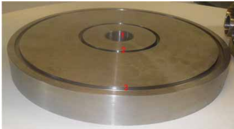
Figura 1. Base da câmara em que se vê o orifício central (1) para entrada da atmosfera experimental e duas ranhuras concêntricas (2 e 3) onde se encaixam os anéis que formarão a câmara interna e externa.
