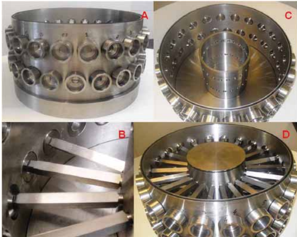
Figura 3. Montagem do anel externo e trompetes - A) Vista do anel externo, com as portas de exposição, sobre a base B) montagem dos trompetes que distribuem a atmosfera para as portas de exposição C) vista interna das câmaras concêntricas D) montagem completa dos componentes internos
