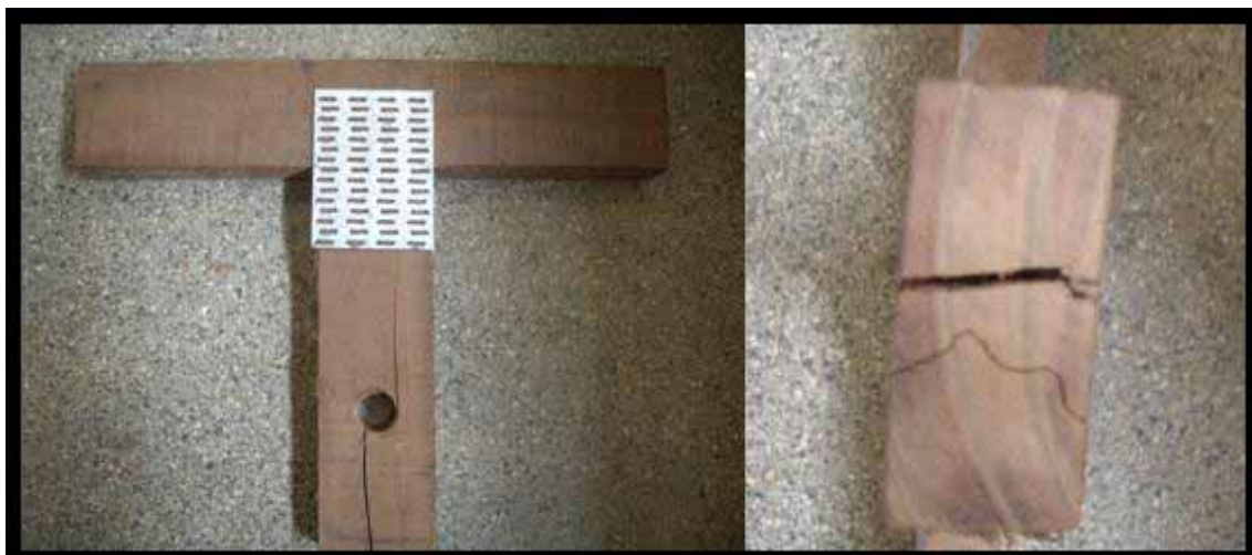
Figura 44 - Corpo –de- prova, porque rompeu no dispositivo.
