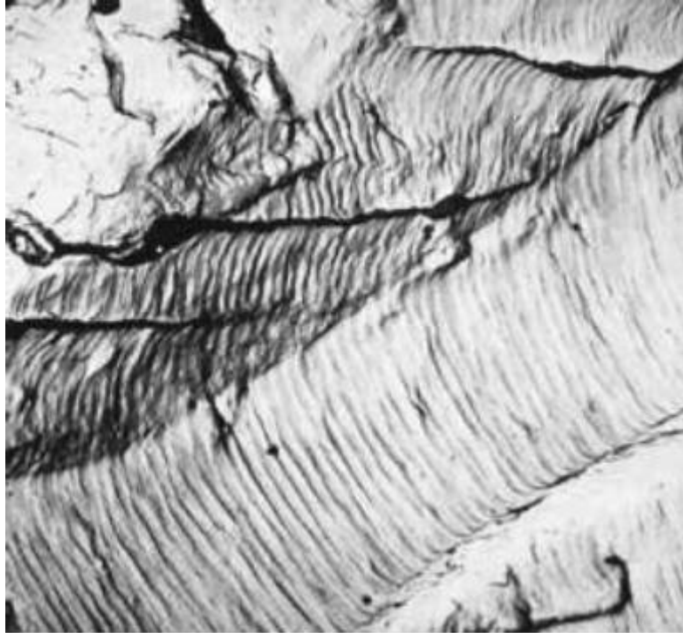
Figura 14 – Morfologia característica do estágio II do processo de fadiga
