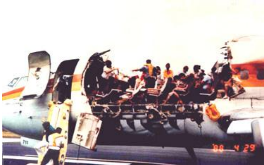
Figura 13 – Fratura por fadiga na fuselagem de um boeing 737
