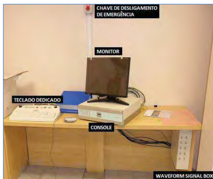
Figura 3: Sala de controle de um Linac. Fonte: do autor.
