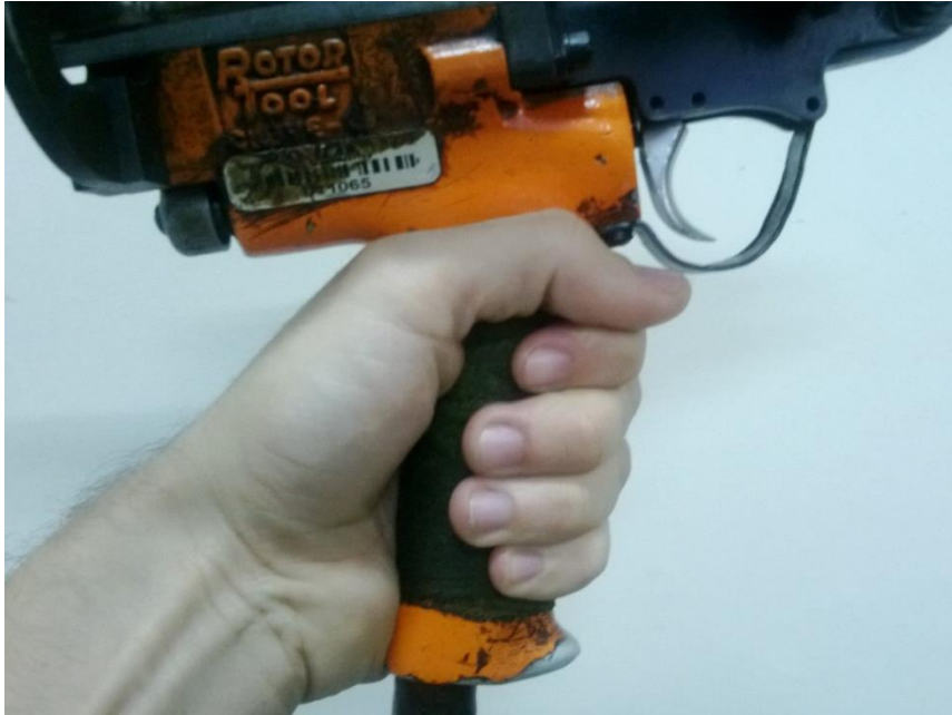
Figura 10: Foto do dispositivo (detalhes do cabo onde é aplicado a força palmar)
