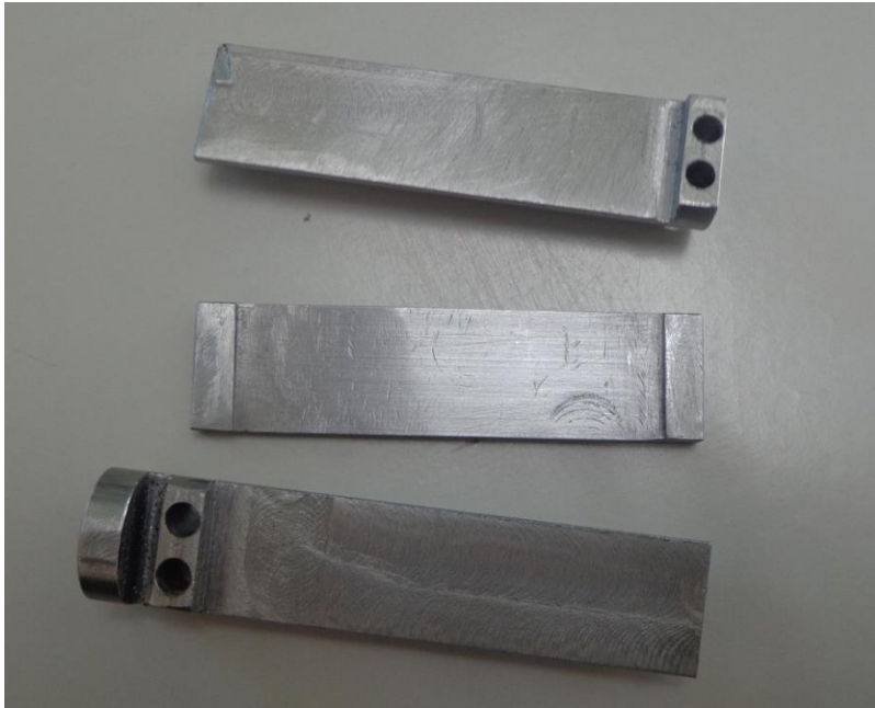
Figura 24: Peças usinadas sem acabamento.
