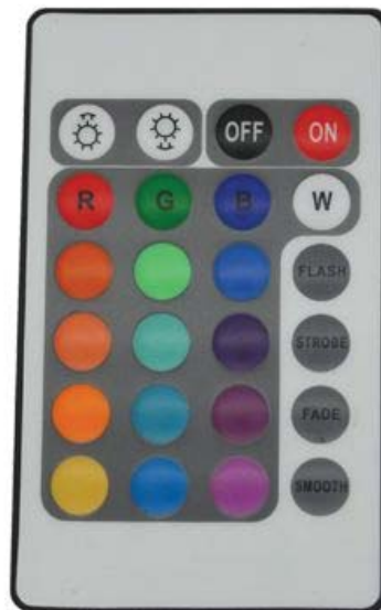
Figura 5: Controle remoto para controle de iluminação.
