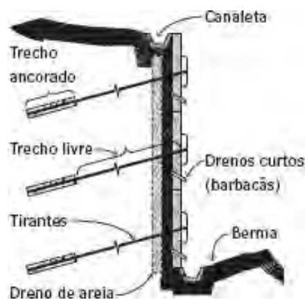
Figura 2.4 – Muro de ancorado (Burgardt, 2011).
