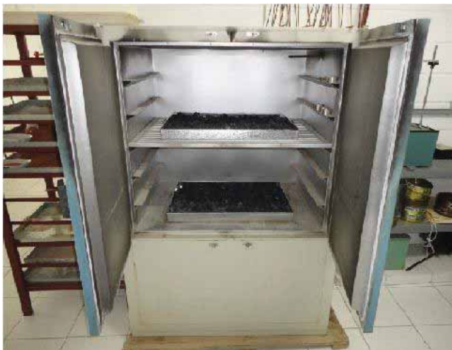
Figura 16 - Secagem do composto dregs-grits em estufa a 105^{\circ}\text{C} \pm 5^{\circ}\text{C} por 24 horas. (ZANELLA, 2011).
