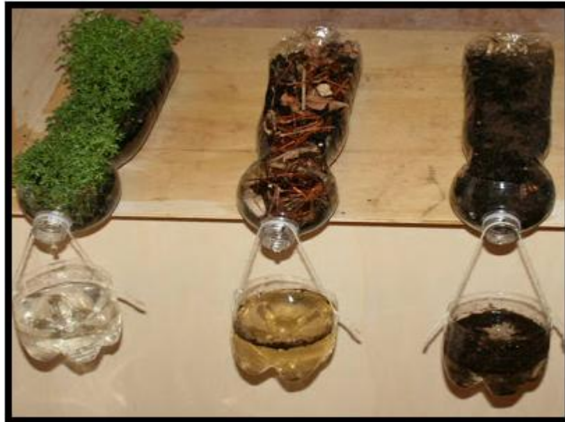
Figura 4: Experimento evidenciando a diferença de arraste de sedimentos em uma superfície vegetada, outra com resíduos vegetais e a última com o solo exposto (esquerda para a direita).
