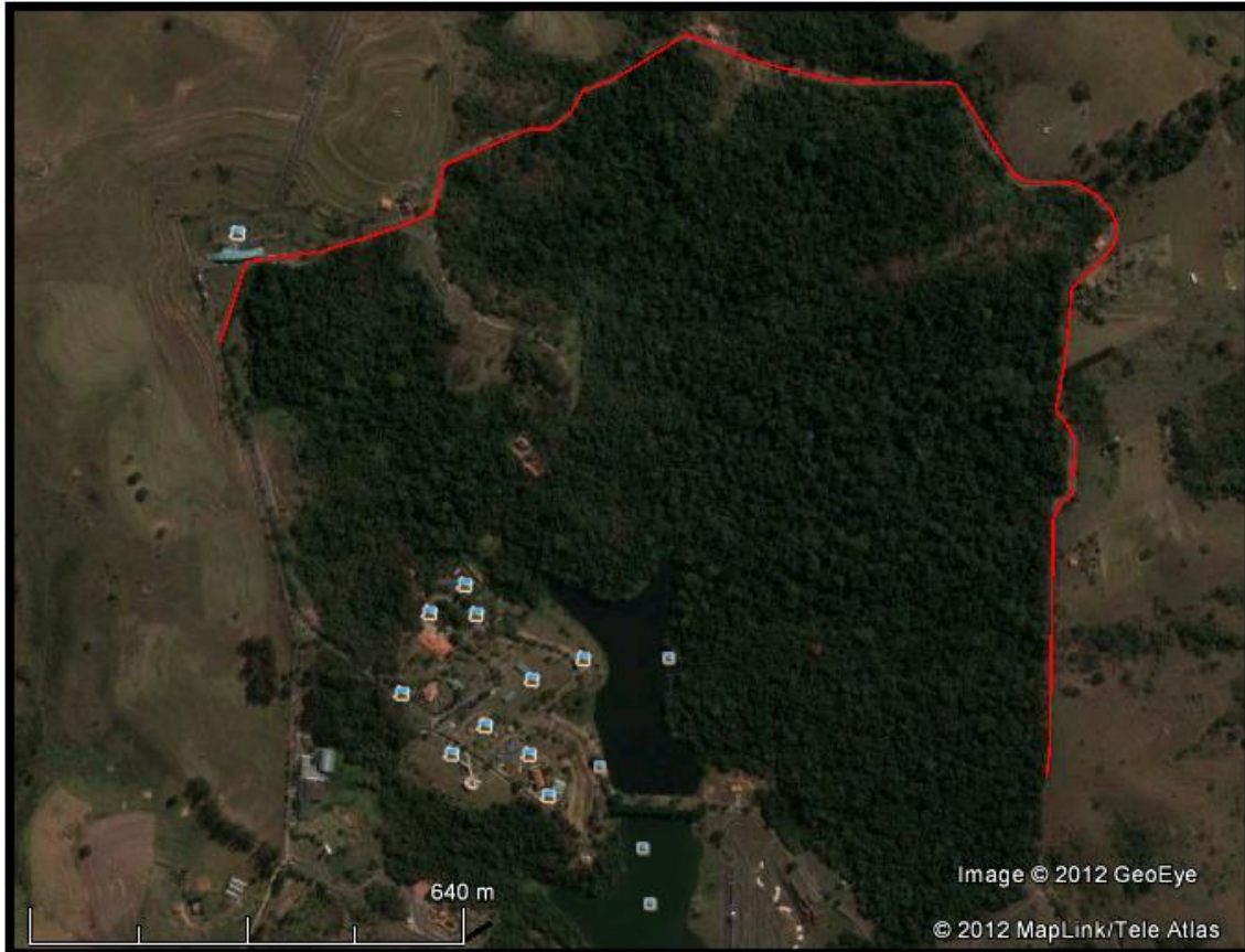
Figura 15: Imagem aérea com o trajeto das vias pavimentadas onde ocorre o escoamento superficial para as bocas de lobo.
