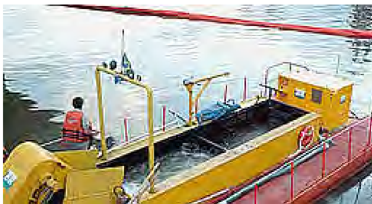
Figura 20 – Barça munida de esteira recolhedora.
