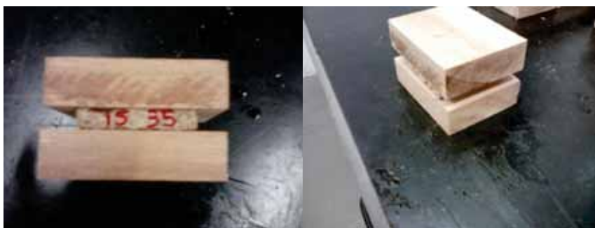
Figura 19 - corpos-de-prova ensaio adesão interna.
