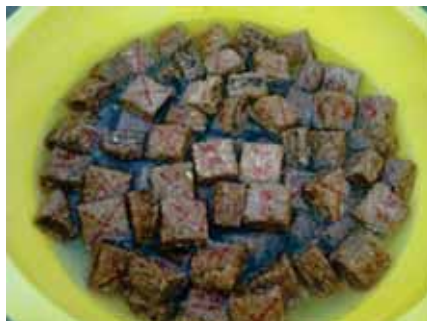
Figura 18 – Corpos de prova submersos após 24 h ± 3 min para determinação do inchamento e absorção de água.
