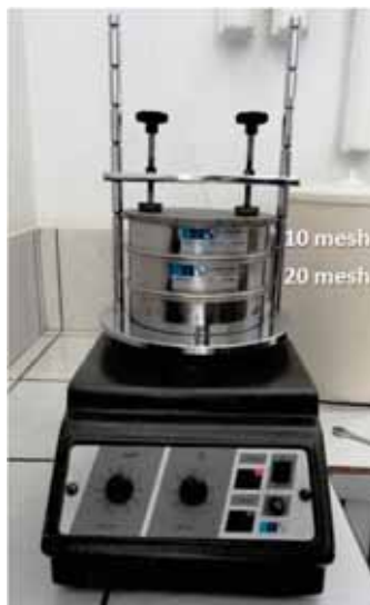
Figura 6 - Agitador de peneiras utilizado para a classificação das partículas.
