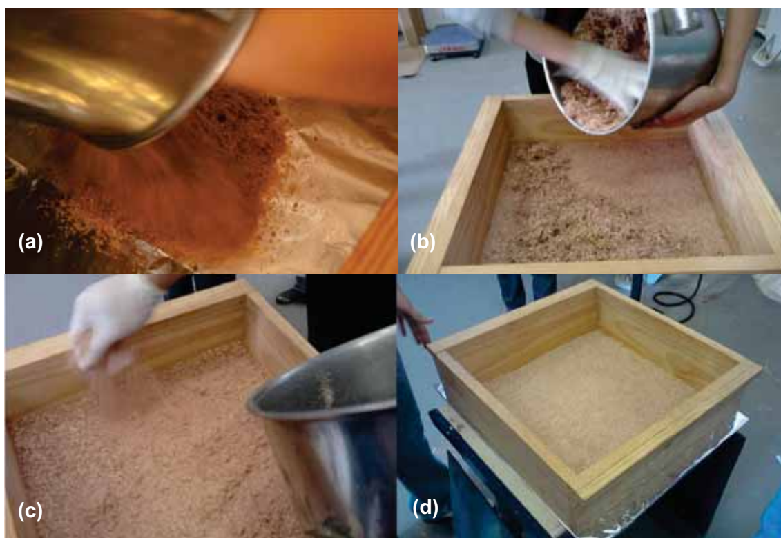
Figura 11 - Formação do colchão: (a) 1ª camada; (b) 2ª camada; (c) 3ª camada; (d) colchão formado.
