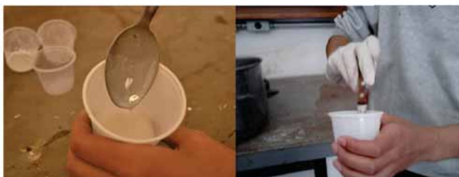
Figura 8 - Adição e mistura de parafina, catalisador e água com adesivo.
