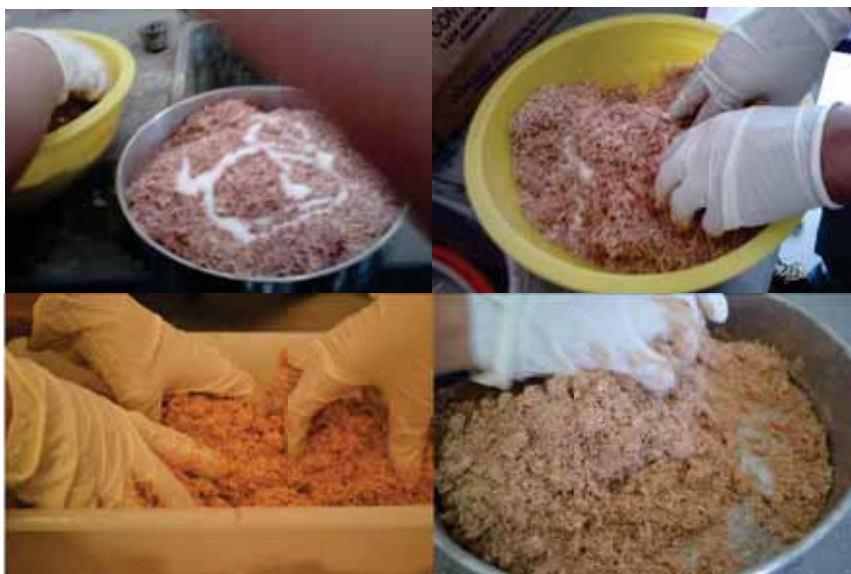
Figura 9 - Adição e mistura manual do adesivo às partículas.
