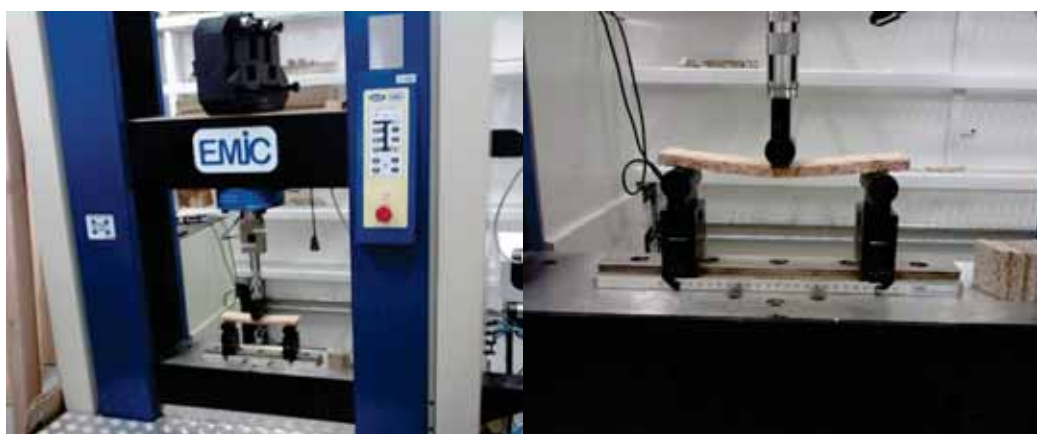
Figura 22 - Ensaio do corpo de prova de flexão estática.
