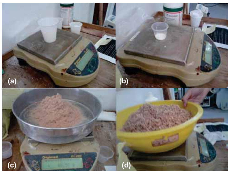
Figura 7 - Pesagem do material: (a) Adesivo; (b) Parafina; (c) Partículas CI; (d) Partículas CE.
