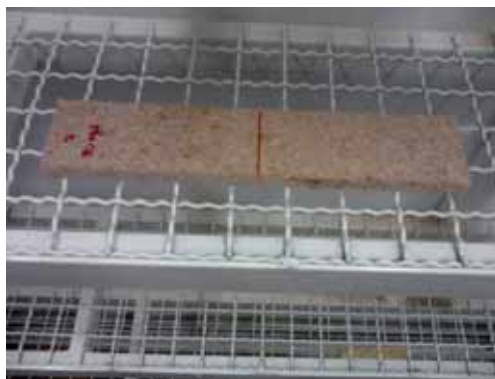
Figura 21 – Corpo de prova ensaio flexão estática acondicionados.
