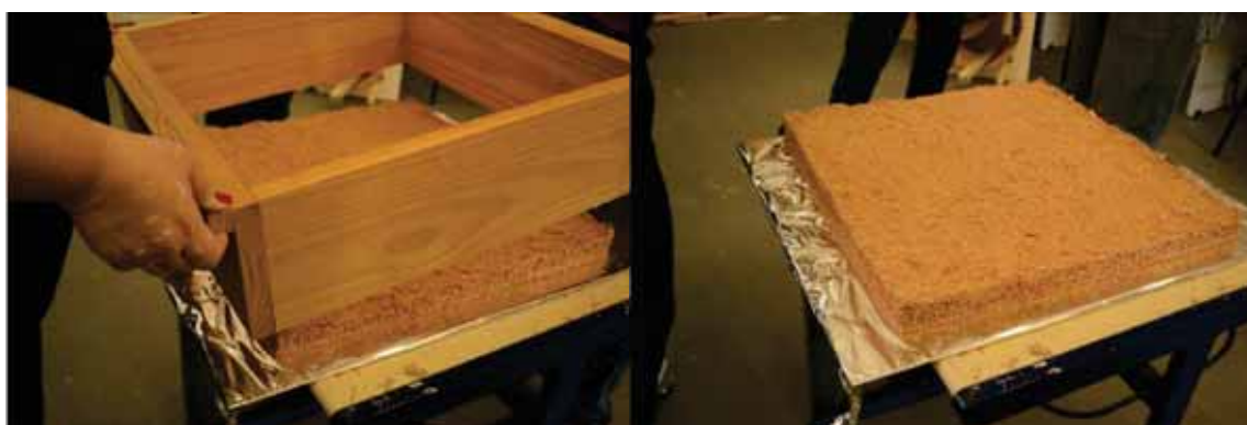
Figura 13 - Retirada do molde para a realização da prensagem a quente.
