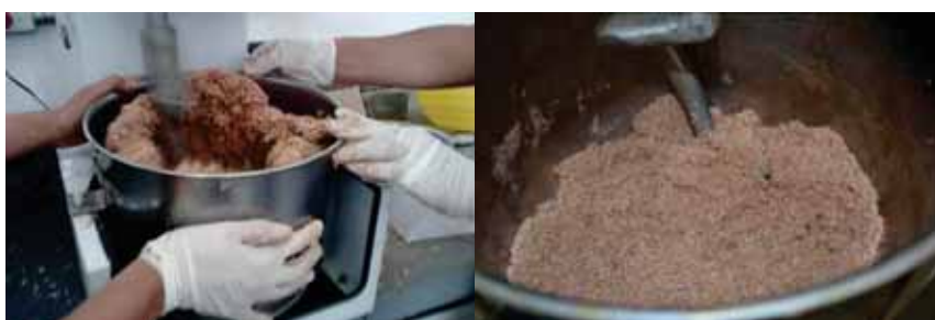
Figura 10 - Misturando o adesivo às partículas com auxílio de uma bateadeira orbital.
