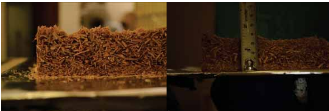
Figura 14 - Espessura do painel antes da prensagem a quente.
