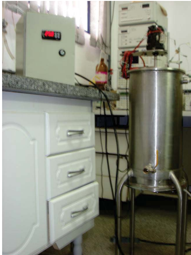
Figura 8. Reator de inox com controle de temperatura (PASSARETTI, 2008)
