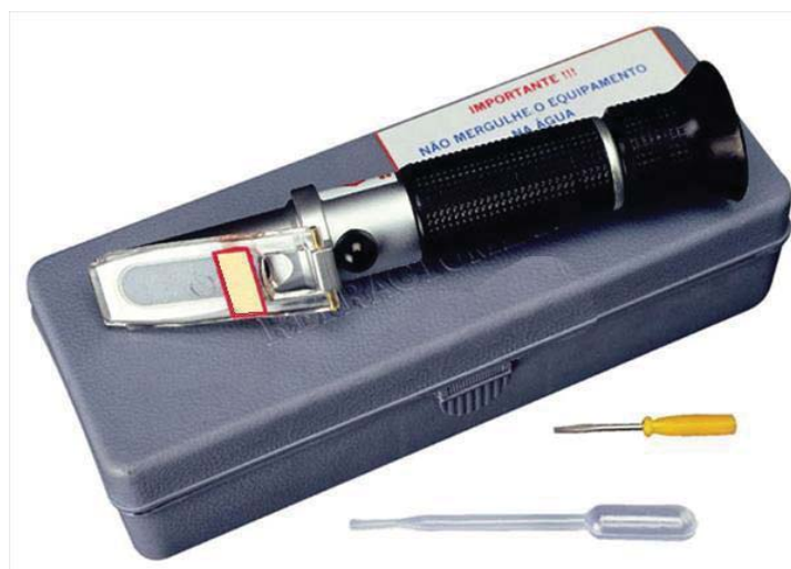
Figura 9. Refratômetro de mão Q-767-2, utilizado para acompanhar a variação do grau brix (densidade da solução) durante o processo de hidrólise (PASSARETTI, 2008).
