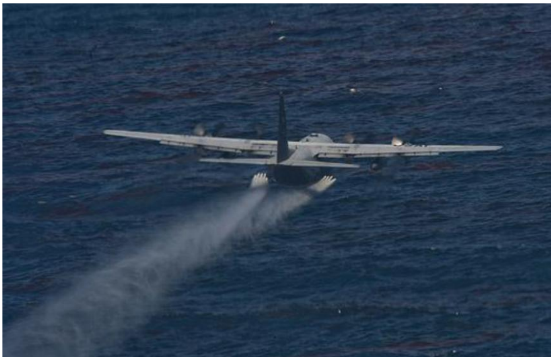
Figura 5 – Aplicação da técnica de dispersão por meio de avião. Fonte: Cetesb International Workshop. Disponível em: < http://www.cetesb.sp.gov.br/userfiles/file/emergencias-quimicas/workshop-mar-2012/dispersantes-queima-in-situ/petrobras-dispersantes-queima-insitu.pdf >. Acesso em: 15 nov. 2013
